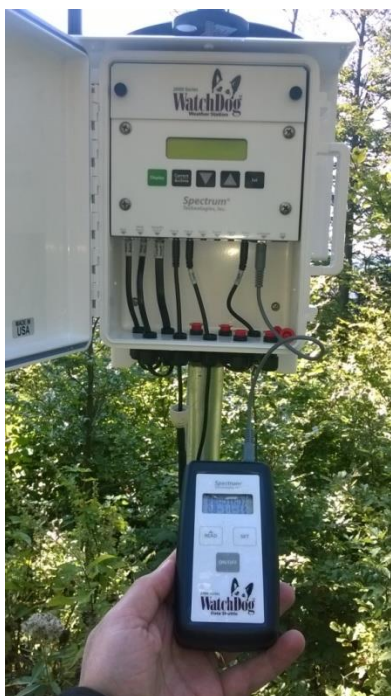
Slika 6. Očitavanje podataka s meteorološke stanice Spectrum
