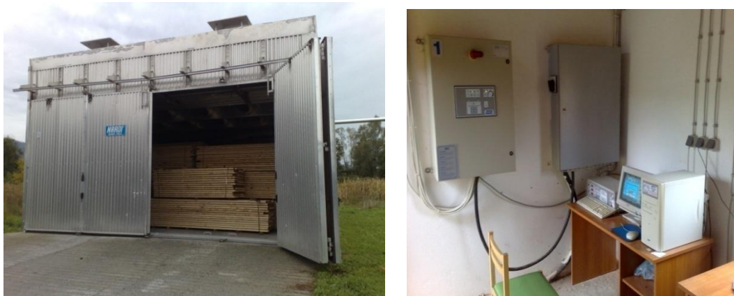
Slika 11. Sušionica i upravljačka jedinica http://drvene-konstrukcije.hr/karakteristike-lld/
