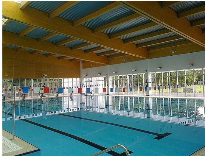
Slika 10. Bazeni u Vinkovcima. Kontinuirana greda raspona 22,50+12,00 m http://drvene-konstrukcije.hr/karakteristike-llld/
