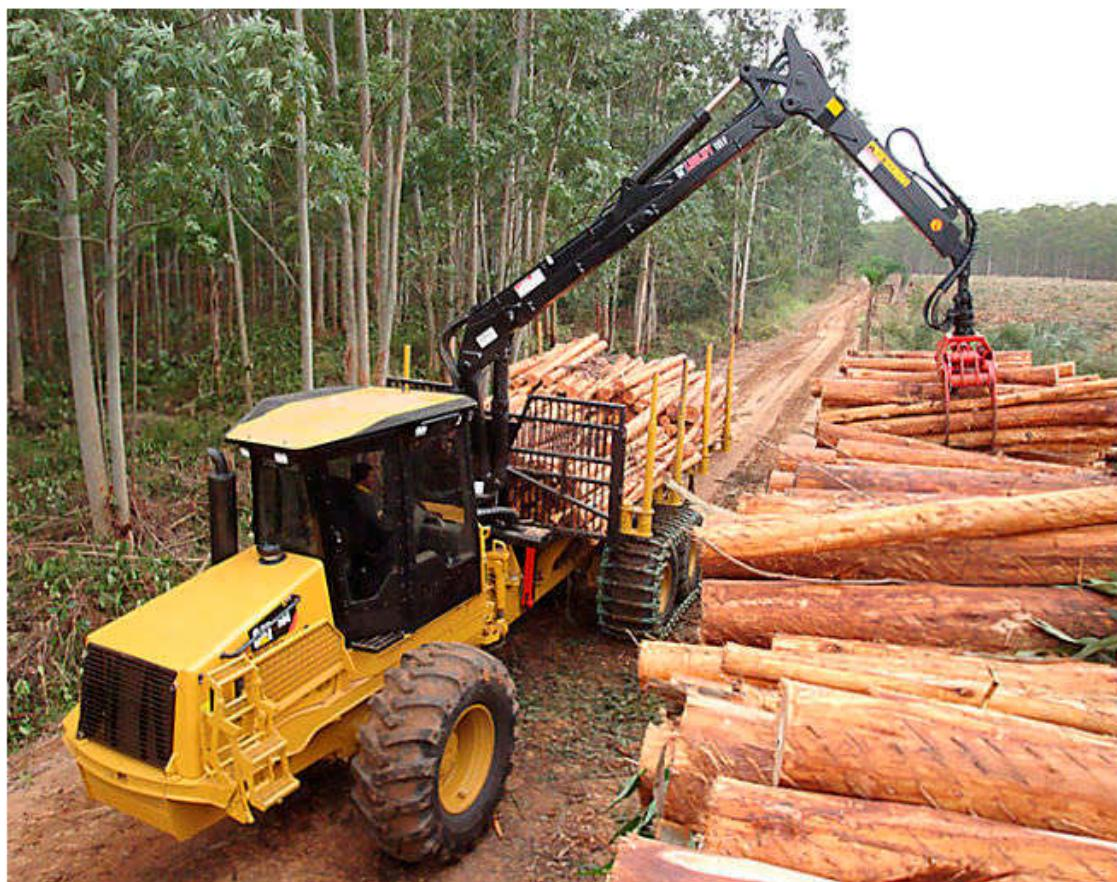
Slika 5. Forvader Caterpillar prilikom istovara na pomoćnom stovarištu
