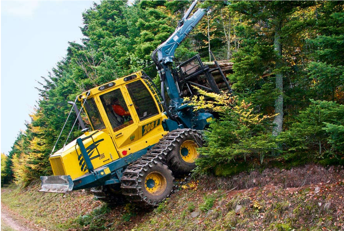
Slika 2. Forvarder HSM 208 F pri svladavanju terenskih prepreka
