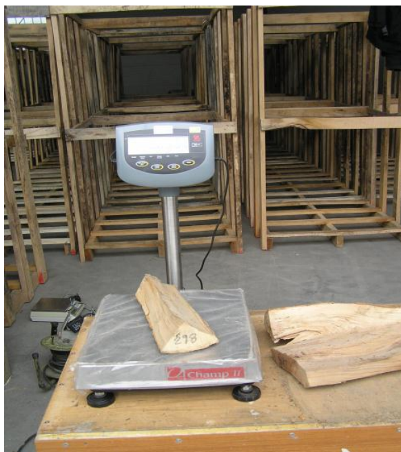
Slika 19. Mjerenje mase cjepanica na laboratorijskoj vazi
