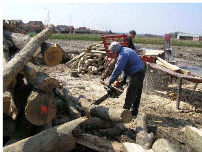
**Slika 13.** Prikraćivanje i izrada metrice oblice motornom lančanom pilom
