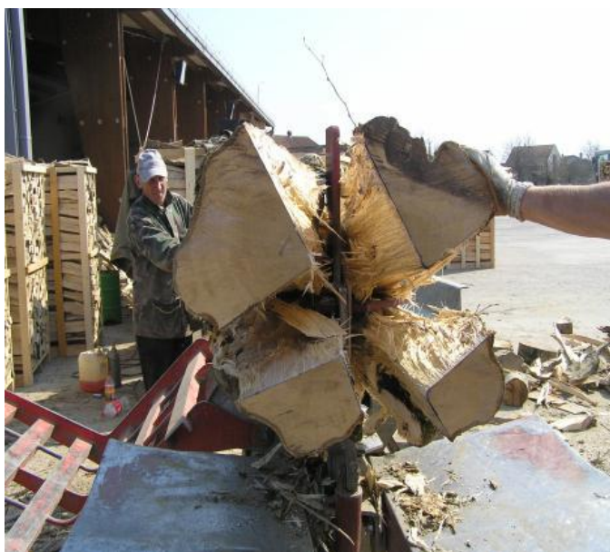
Slika 14. Cjepanje metrice oblice
