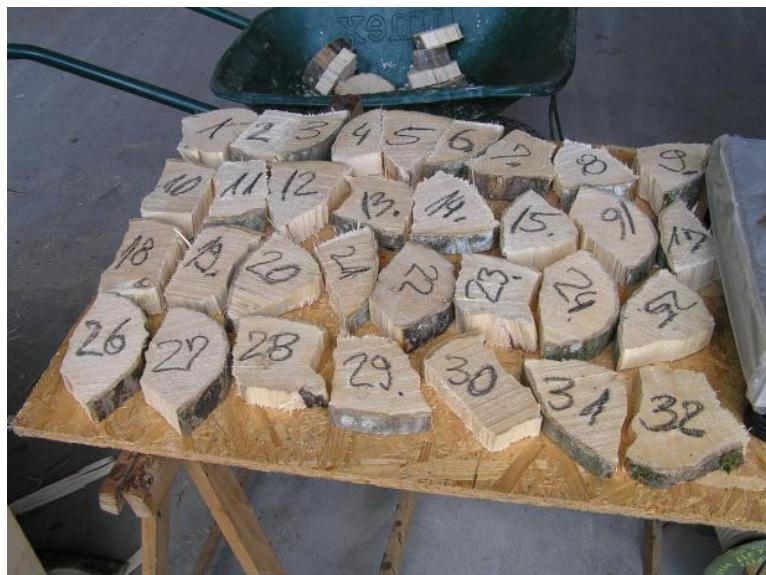
**Slika 21.** Uzorci iz cjepanica za mjerjenje vlage gravimetrijskom metodom
