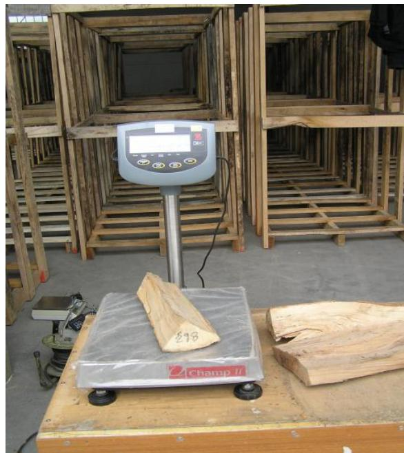
**Slika 19.** Mjerenje mase cjepanica na laboratorijskoj vazi
