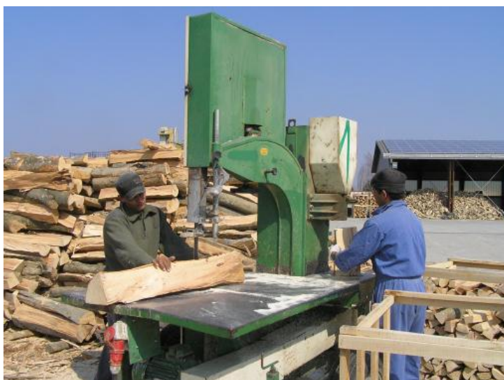
Slika 15. Prikraćivanje cjepanice metrice stolarskom tračnom pilom
