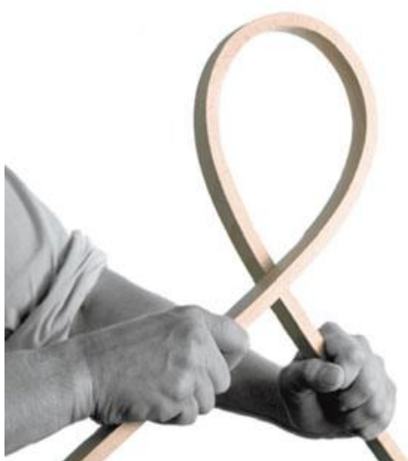
Slika 14. Savijanje materijala Bendywood ®
