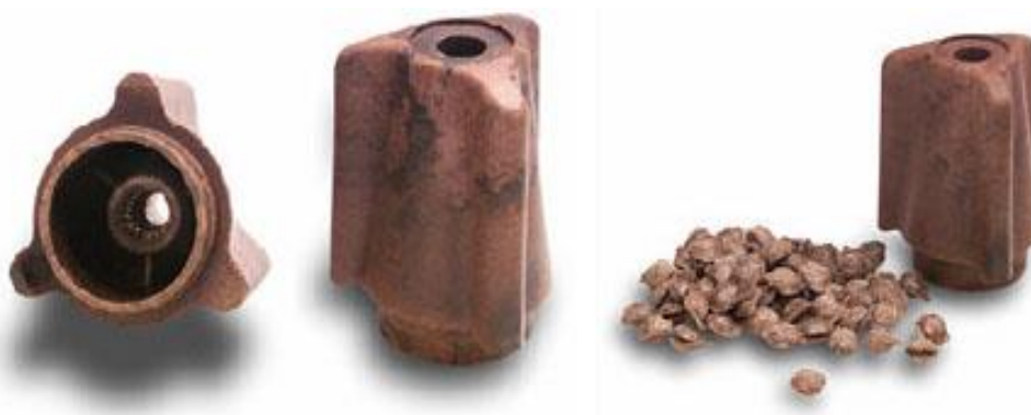
Slika 15. Granule i proizvod od materijala Arboform ®
