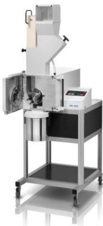
Mlin rezni Retsch SM 300 se koristi za usitnjavanje različitih tipova uzoraka rezanjem. Prikladan je za usitnjavanje mekih, srednje tvrdih, tvrdih, elastičnih, vlaknastih i heterogenih mješavina uzoraka. Ima raspon podešavanja brzine vrtnje od 700 do 3000 min<sup>-1</sup>. Sadrži rotor sa šest diskova te ima sito trapezoidnog otvora oko dimenzija 1 mm za usitnjavanje bez kontaminacije teškim metalima.
