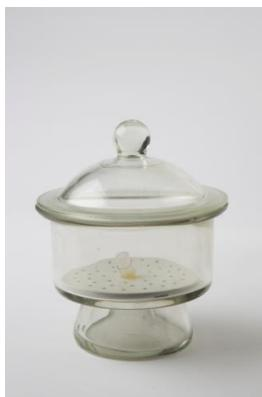
Eksikator koristi se za polagano sušenje i čuvanje tvari koje lako apsorbiraju vlagu iz zraka. Na dnu eksikatora se nalazi hidroskopni materijal koji apsorbira samu vlagu iz uzorka. Najčešće se izrađuju od debelog lijevanog stakla i zatvaraju se poklopcom čije brušene dijelove treba namazati vazelinom kako bi postali nepropusni za zrak.
