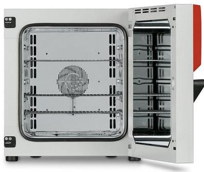
Sušionik Binder FD 115 se koristi prilikom gravimetrijskih analiza. Volumen radnog prostora iznosi 115l. Raspon podešavanja temperature je od +5 °C iznad temperature okoline do 300 °C (rezolucija 1 °C). Ima podesivu prednja ventilacijska zaklopka i stražnji ispuh promjera 50 mm
