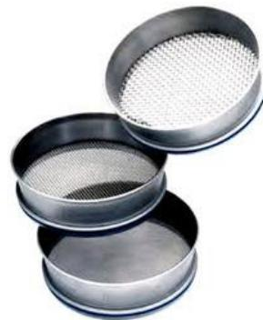
Tresilica sita vibracijska Retsch AS 400 control se koristi za utvrđivanje granulometrijske strukture uzoraka. Sastoji se od sita promjera 400 mm. Ujednačeno se kružno horizontalno gibaju
