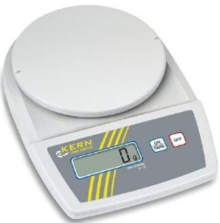
Prijenosna digitalna vaga Kern EMB koristi se za određivanje mase uzoraka. Maksimalna masa vaganja iznosi 6000 g s preciznošću očitanja 0,01g.
