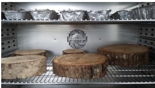
Slika 12. Uzorci kolotova i drvene sječke u sušioniku
