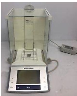
Vaga analitička Mettler Toledo, XA 204 DR se koristi za određivanje mase uzorka. Maksimalna težina vaganja iznosi 80 / 220 g. Preciznost očitanja je 0,01 / 0,1 mg.
