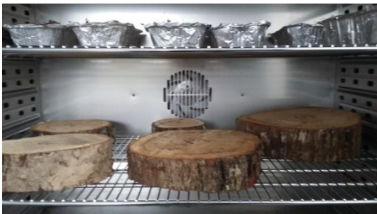
Slika 12. Uzorci kolotova i drvene sječke u sušioniku
