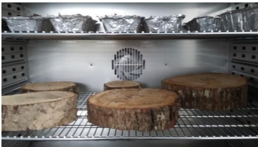
Slika 12. Uzorci kolotova i drvene sječke u sušioniku
