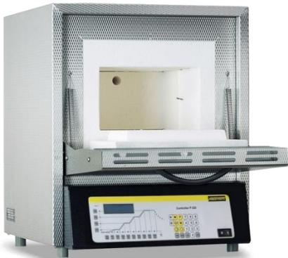
Mufolna peć Nabertherm L9/11 se rabi za kontrolirano žarenje laboratorijskih uzoraka radi određivanja udjela mineralnih tvari (pepela). Ima podizna vrata. Nominalna temperatura iznosi 1100 °C. Kontrola temperature termočlankom NiCr-Ni. Upravljački kontroler P 330. Ima mogućnost programiranja temperturnih gradijenata i rampi. Sadrži dimnjak s ventilatorom i katalizatorom.
