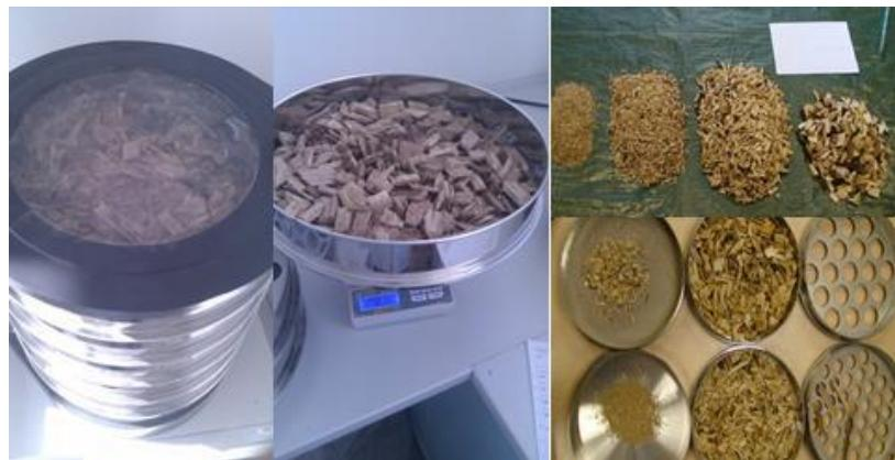
Slika 19. Oscilator za utvrđivanje granulometrijskog sastava drvne sječke
