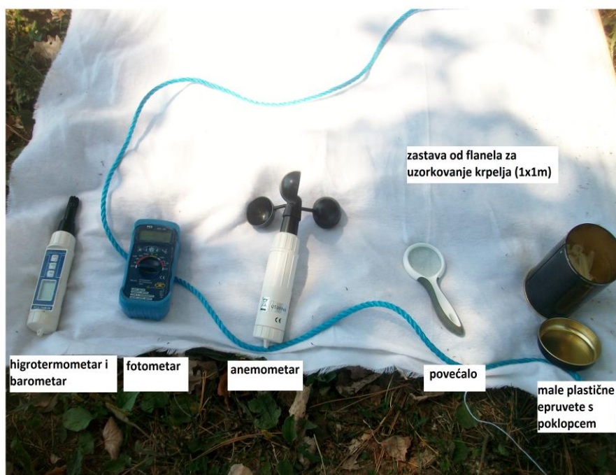
Slika 25. Instrumenti i oprema korišteni na terenu
