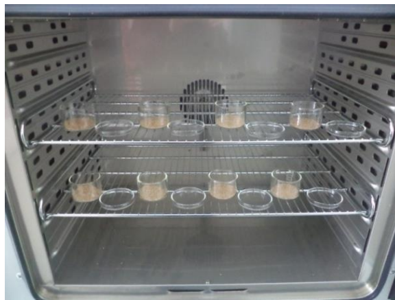
Slika 13. Uzorci u sušioniku Binder FD 115
