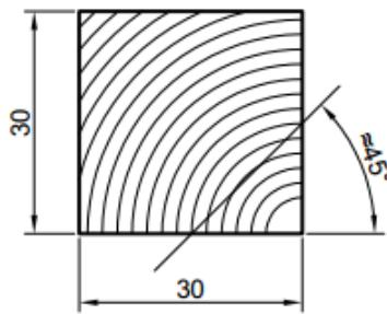
Slika 4. Radijalno - tangentna tekstura
