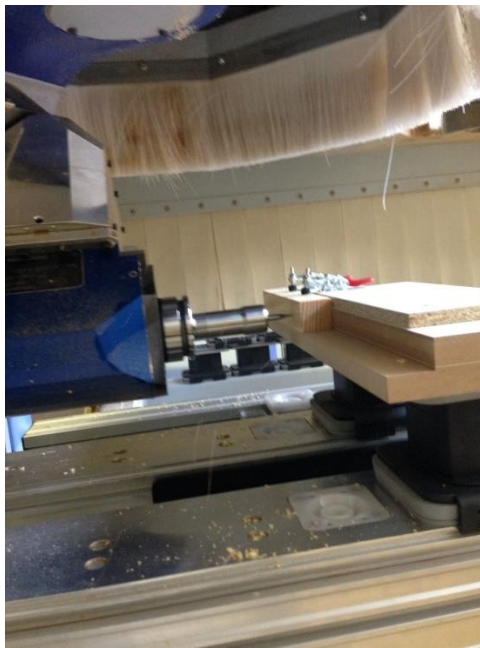
Slika 11. Bušenje provrta za mjerne sonde na uzorku borovine
