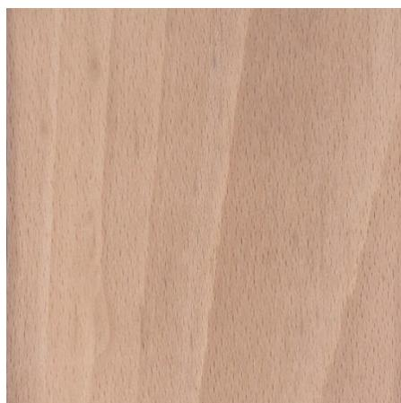
Slika 3 Tangentni presjek bukovine<sup>32</sup>
