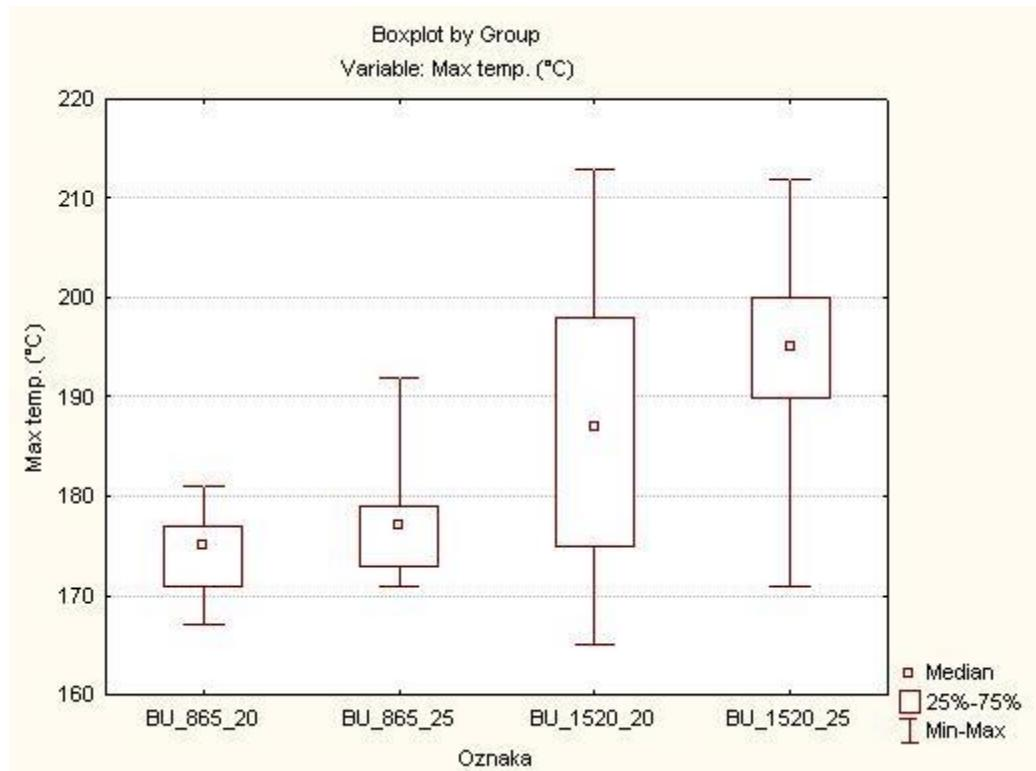
Slika 31. Usporedba temperature zavarivanja bukovine
