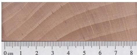
Slika 2 Poprečni presjek bukovine<sup>31</sup>
