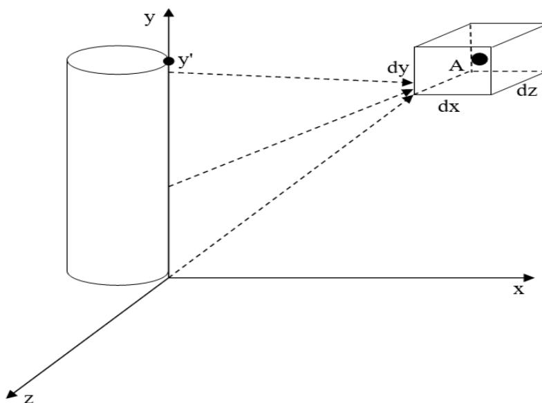
Slika 32. Zavarivanje drva u trodimenzionalnom pravokutnom koordinatnom sustavu. A – točka u kojoj se mjeri temperatuta
