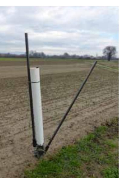
Ovom sadilicom sadnja se znatno ubrzava. Zaostrenim vrhom se probada kroz foliju. Kroz cijev se ubacuje sadnica.
