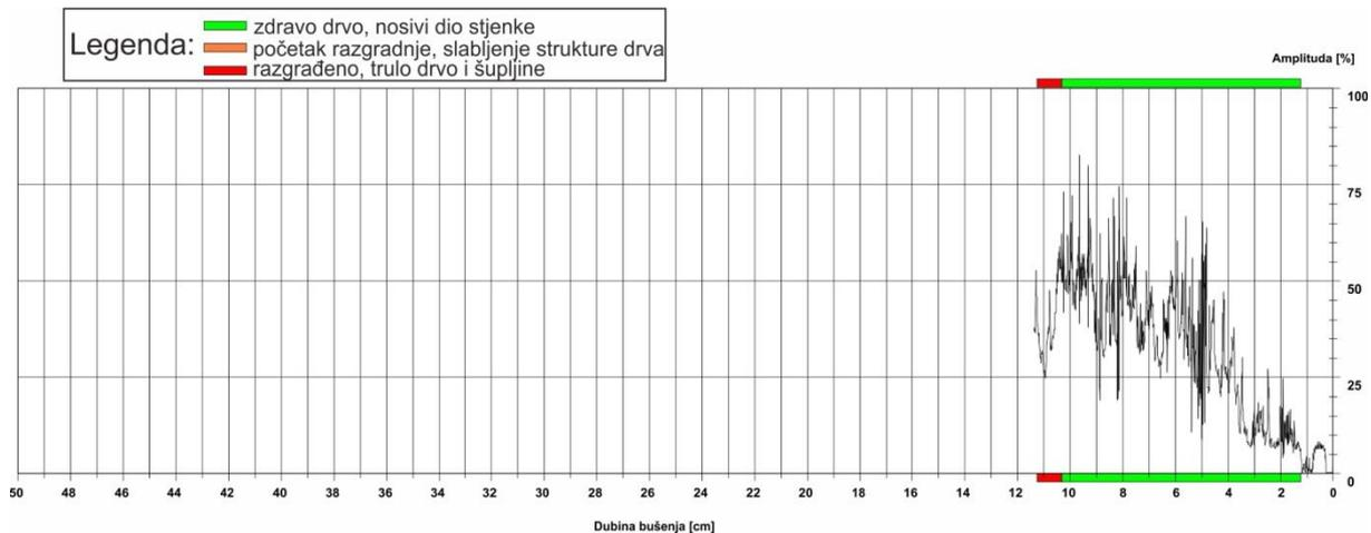
Slika 19: Rezistogram bušenja 7
