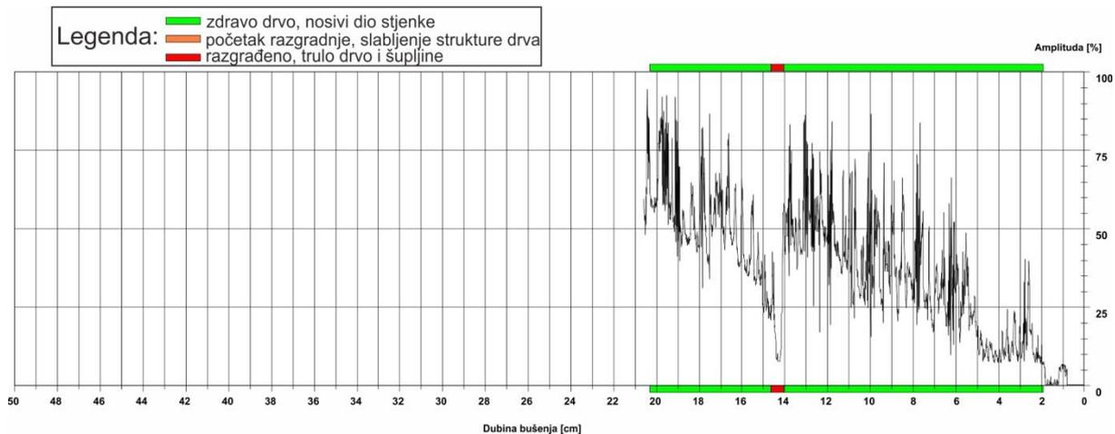
Slika 28: Rezistogram bušenja broj 12
