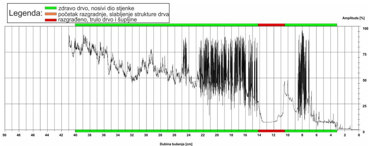
Slika 33: Rezistogram bušenja 15
