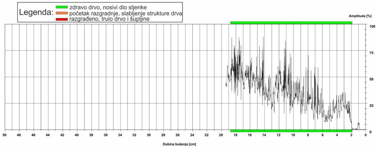
Slika 16: Rezistogram bušenja 3
