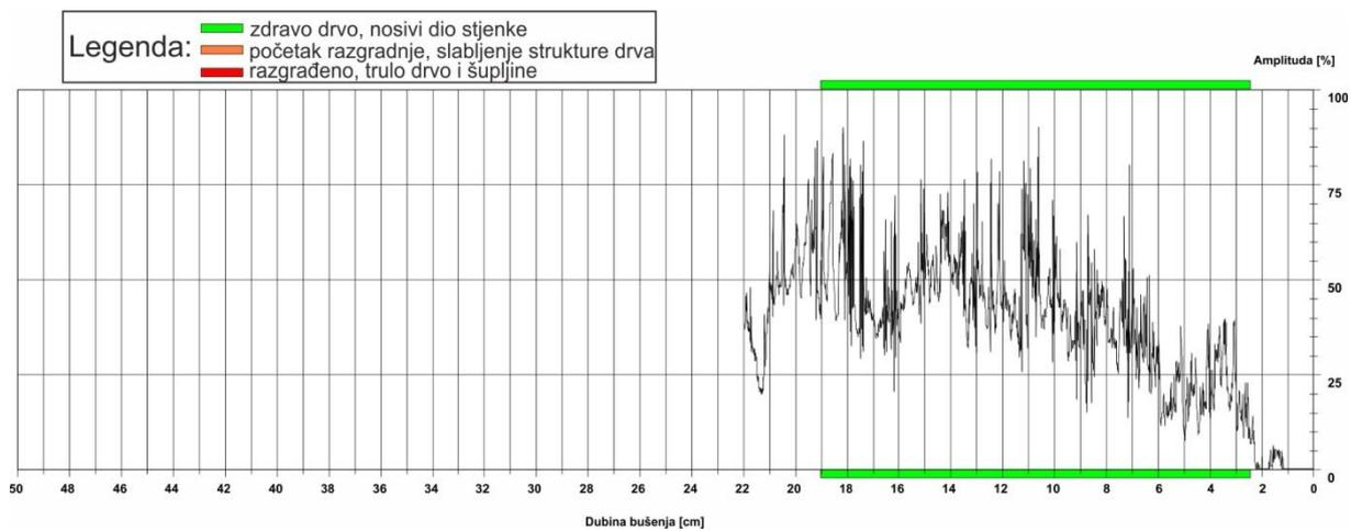
Slika 21: Rezistogram bušenja 6.1
