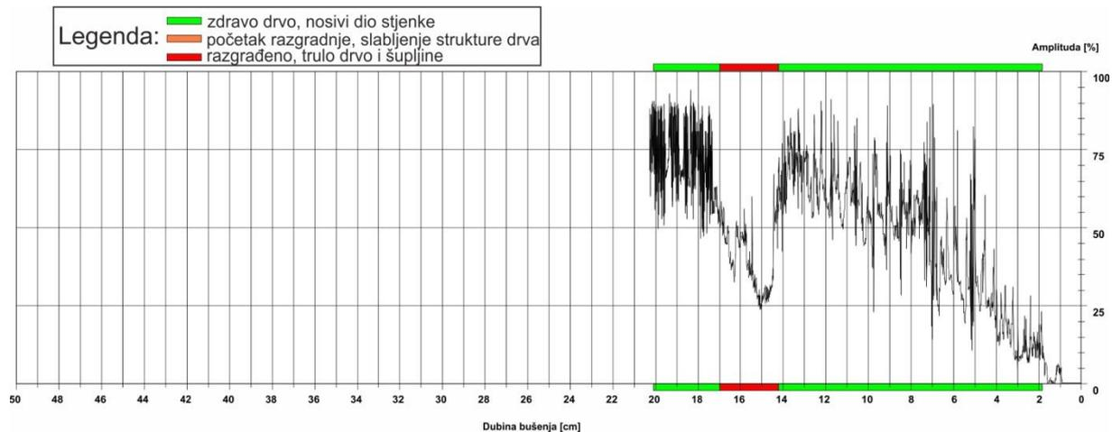
Slika 25: Rezistogram bušenja 10
