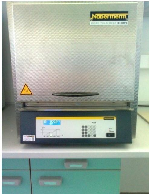
Slika 16. Peć za žarenje Nabertherm L911
