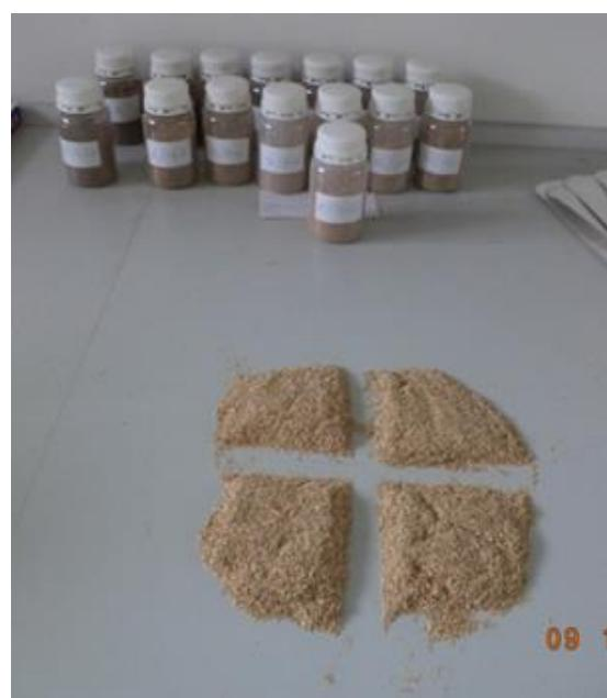
Slika 11. Priprema kompozitnih uzoraka
