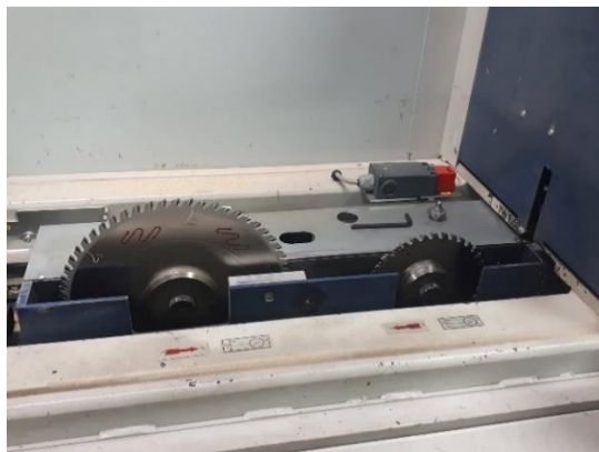
Slika 13. Predrezač i glavna pila za krojenje elemenata
