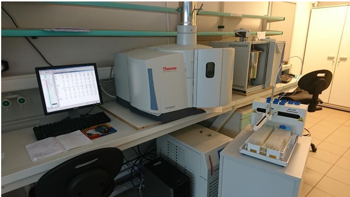
Slika 6. Atomski emisijski spektrometar uz induktivno spregnutu plazmu (ICP-AES) Thermo Fisher, iCAP 6300 (foto: I. Perković)
