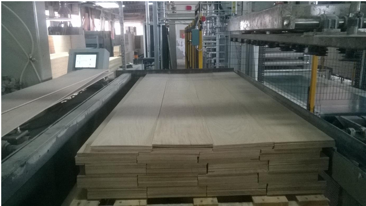
Slika 13. Priprema lica (1 strip) prije ulaska u prešu.
