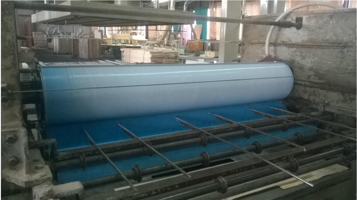
Slika 11. Nanos lijepila prije prešanja.
