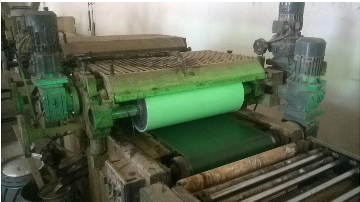
Slika 22. Gumeni valjak za nanošenje laka.
