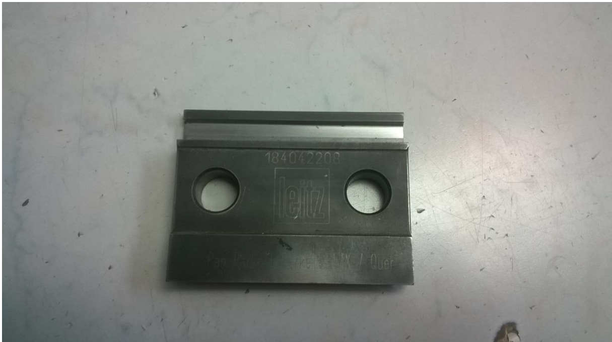
Slika 30. Kontrolna šablona za profile.
