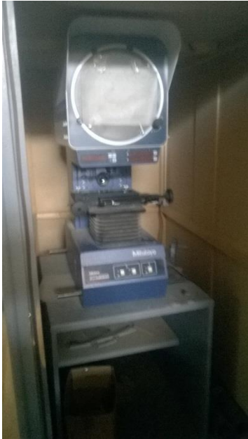
Slika 24. Grafoskop za kontrolu kvalitete u izradi profila
