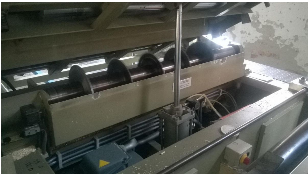
Slika 16. Pile na višelisnom cirkularu za raspiljivanje slijepljenih ploča u parketne daske.
