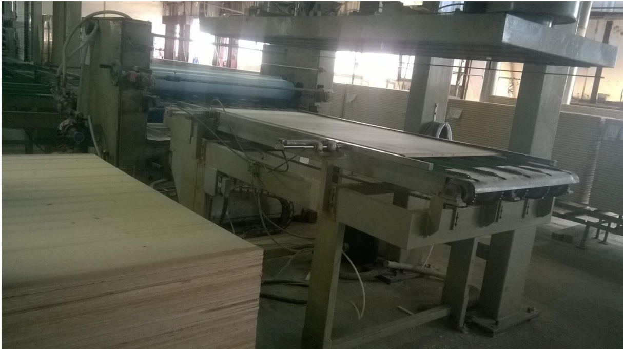
Slika 10. Na slici je prikazan srednji sloj parketa kako ulazi u proces prešanja (prolazak između valjaka za lijepljenje)
