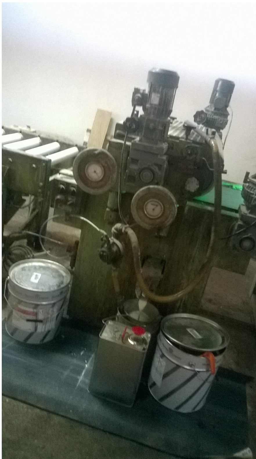
Slika 23. Doziranje laka preko zračne pumpe.
