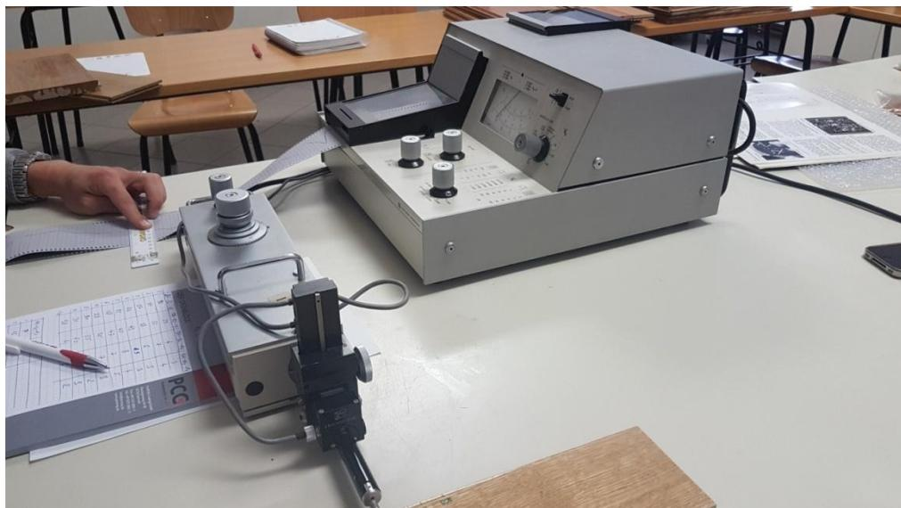
Slika 29 instrument za kontaktno mjerjenje hrapavosti površine
