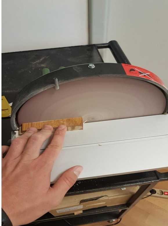
Slika 16. rotacijska brusilica (P240)
