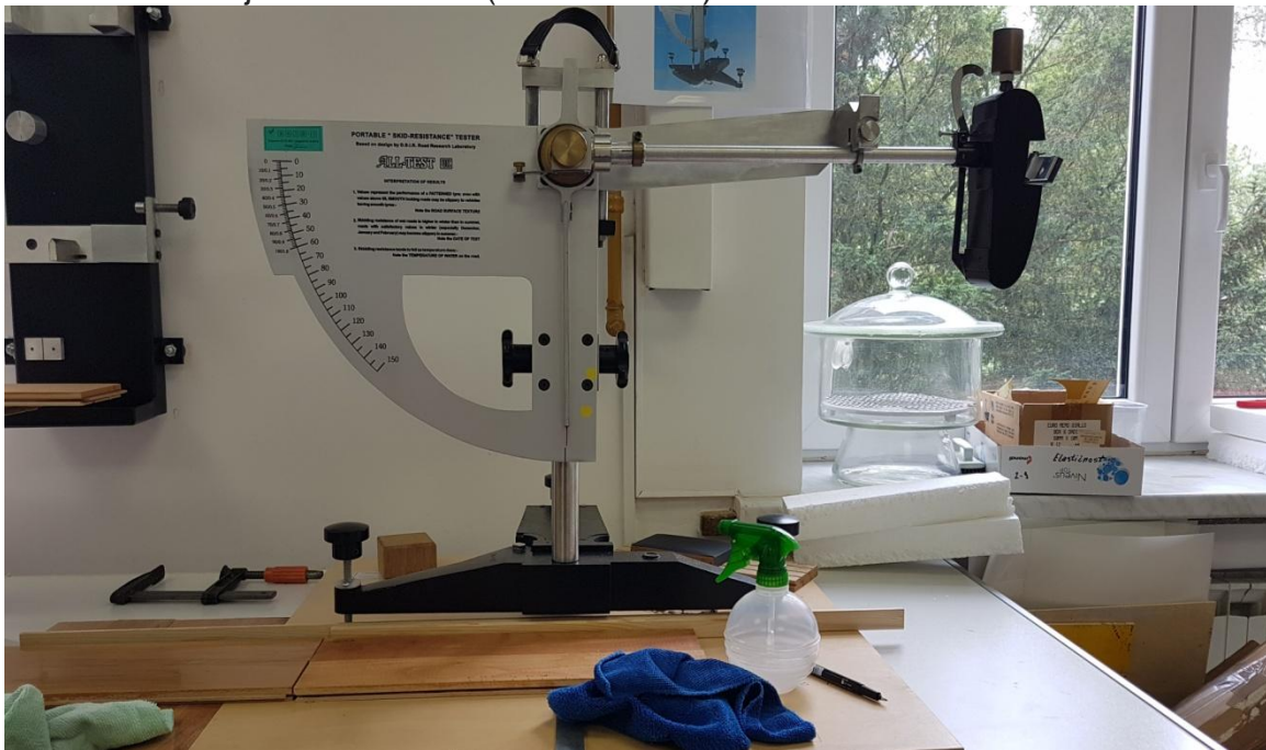
Slika 23 priprema ispitivanja klizavosti površine prilikom utjecaja vode
