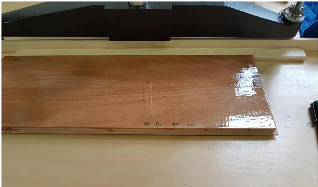
Slika 22 Ispitivanje klizavosti na "suho"
