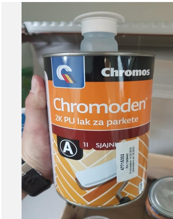
Slika 6. Komponenta A završnog laka
