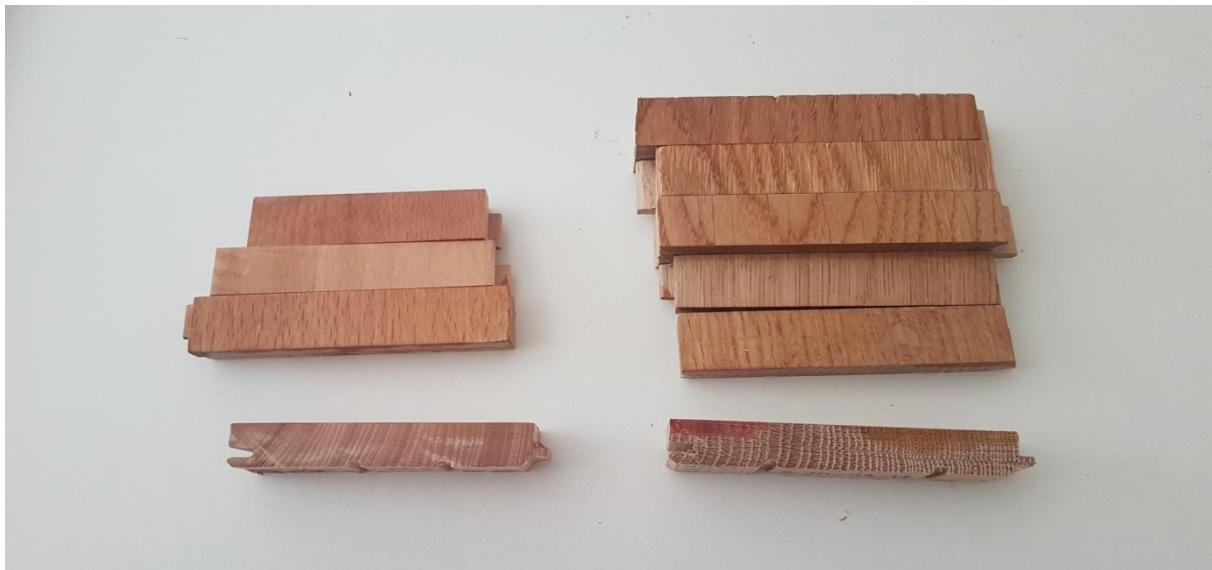
Slika 15. uzorci za mjerjenje debljine filma
