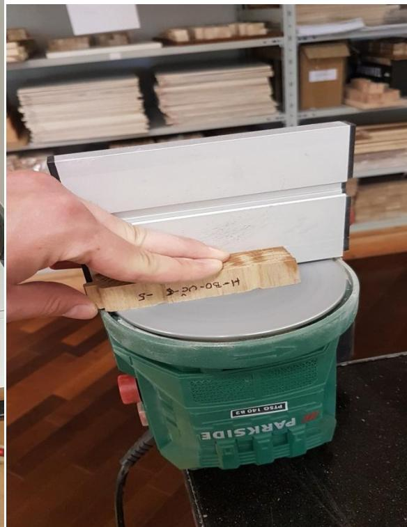
Slika 17. rotacijska brusilica (P1200)
