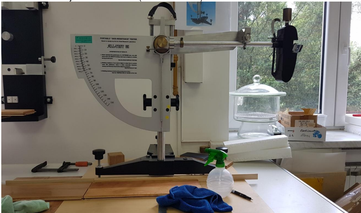
Slika 23 priprema ispitivanja klizavosti površine prilikom utjecaja vode
