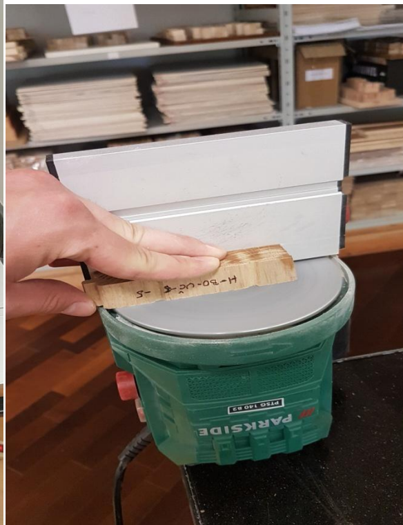
Slika 17. rotacijska brusilica (P1200)
