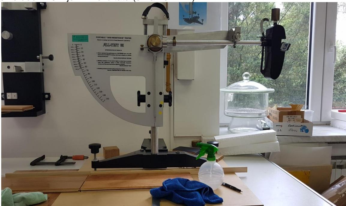
Slika 23 priprema ispitivanja klizavosti površine prilikom utjecaja vode
