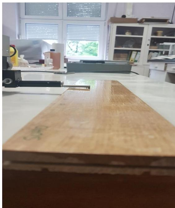
Slika 28 mehanički kontakt između igle i površine
