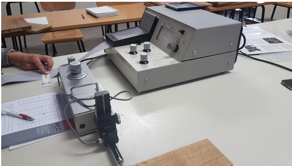
Slika 29 instrument za kontaktno mjerenje hrapavosti površine
