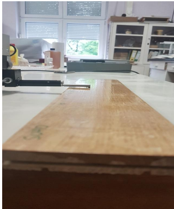
Slika 28 mehanički kontakt između igle i površine
