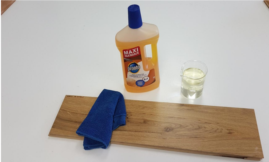
Slika 27 priprema uzorka za ispitivanje klizavosti nanošenjem pronto sredstva za čišćenje
