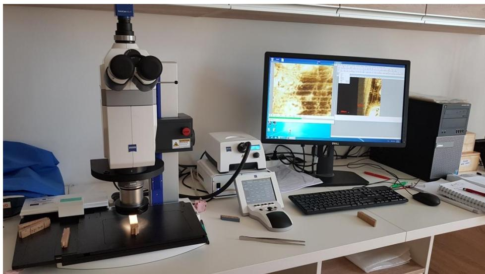
Slika 18. kompjutor i mikroskop za mjerjenje debljine filma
