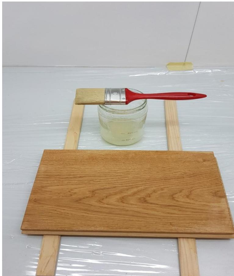
Slika 14. nanošenje ulja kistom
