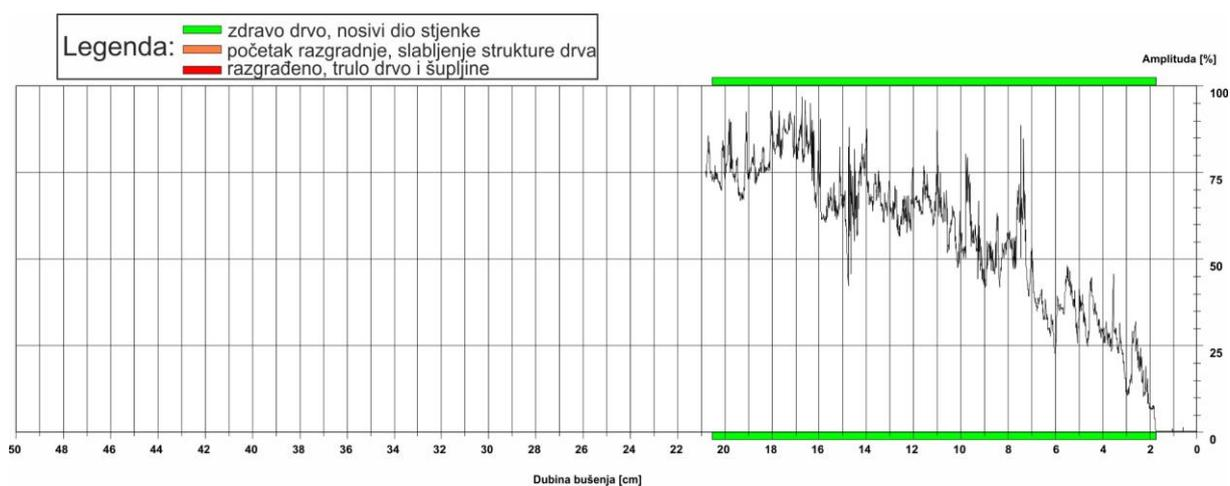
Slika 18: Rezistogram bušenja 5.1
