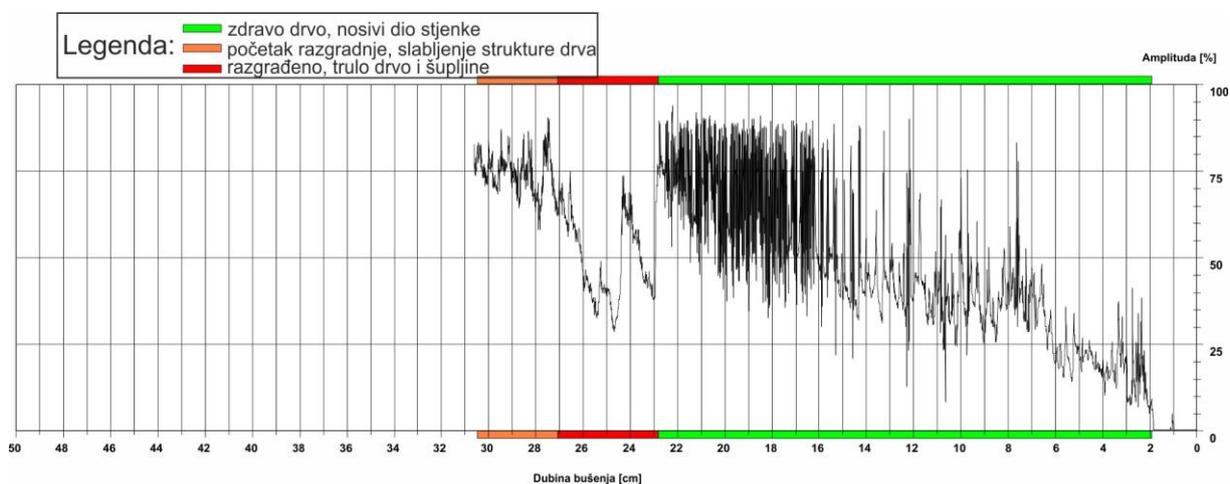
Slika 26: Rezistogram bušenja 11
