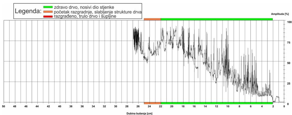
Slika 27: Rezistogram bušenja 11.1
