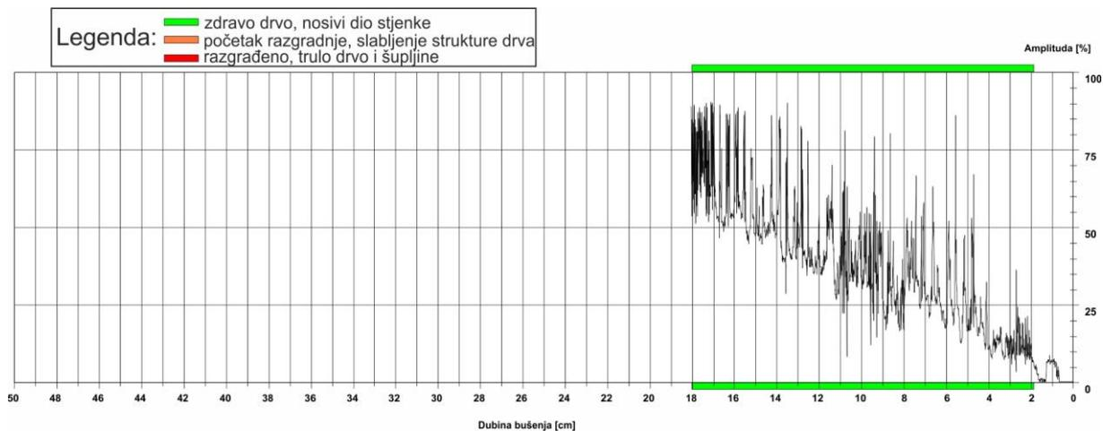
Slika 14: Rezistogram bušenja 1
