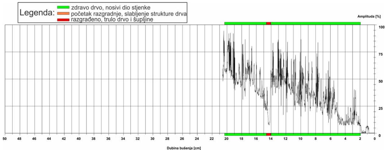
Slika 28: Rezistogram bušenja broj 12
