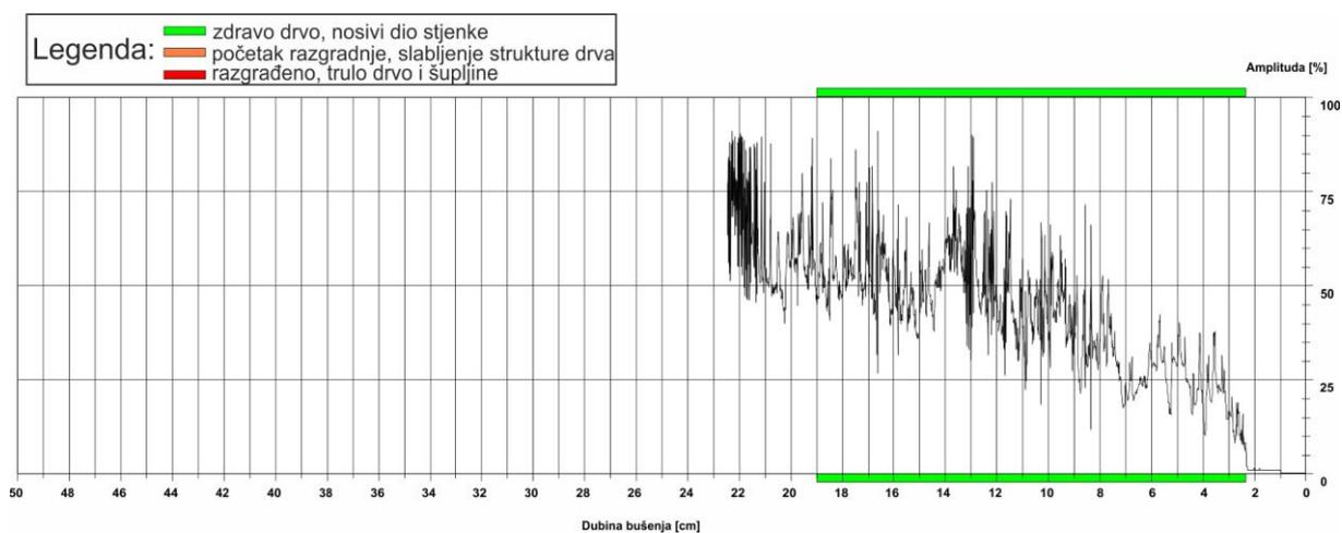
Slika 20: Rezistogram bušenja 6
