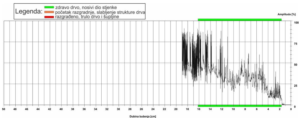
Slika 24: Rezistogram bušenja 9
