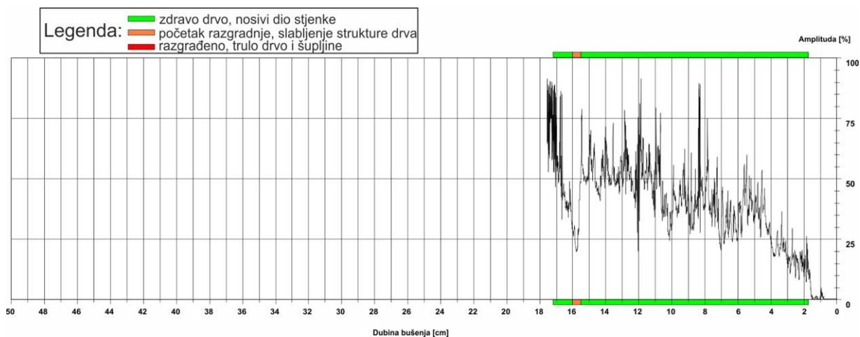
Slika 15: Rezistogram bušenja 2
