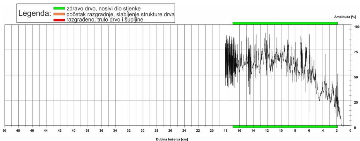
Slika 23: Rezistogram bušenja 8.1
