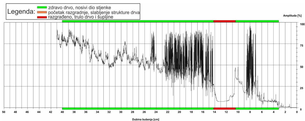
Slika 33: Rezistogram bušenja 15
