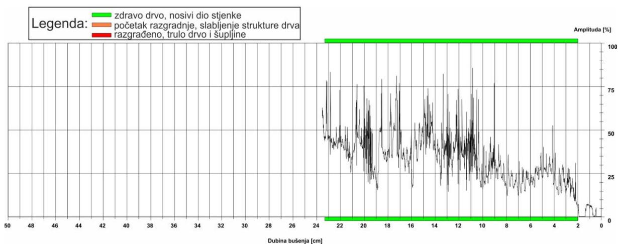
Slika 30: Rezistogram bušenja 13
