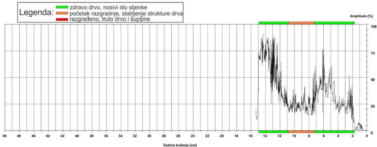
Slika 31: Rezistogram bušenja 13.1
