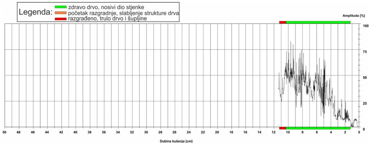
Slika 19: Rezistogram bušenja 7
