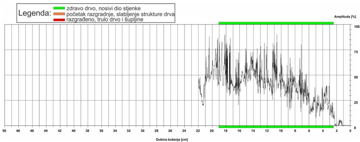
Slika 21: Rezistogram bušenja 6.1
