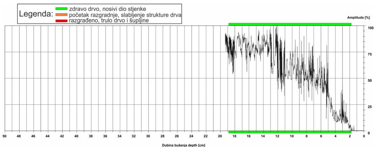
Slika 32: Rezistogram bušenja 14
