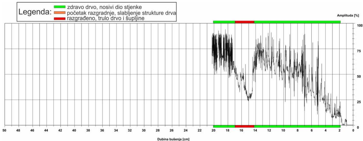
Slika 25: Rezistogram bušenja 10
