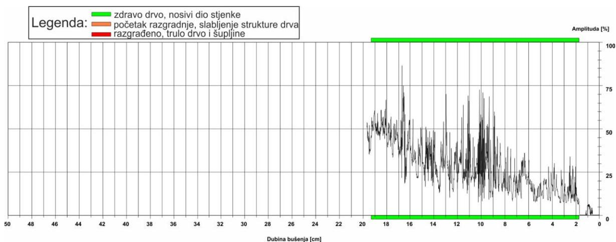
Slika 17: Rezistogram bušenja 5
