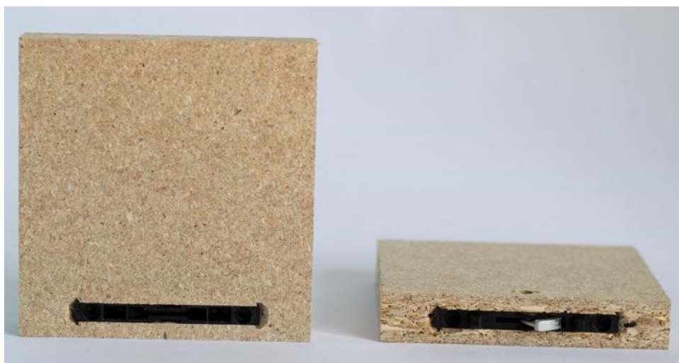
Slika 12 - Lamello Clamex P 15 u rastavljenoj formi kod troslojne iverice (fotografija:
