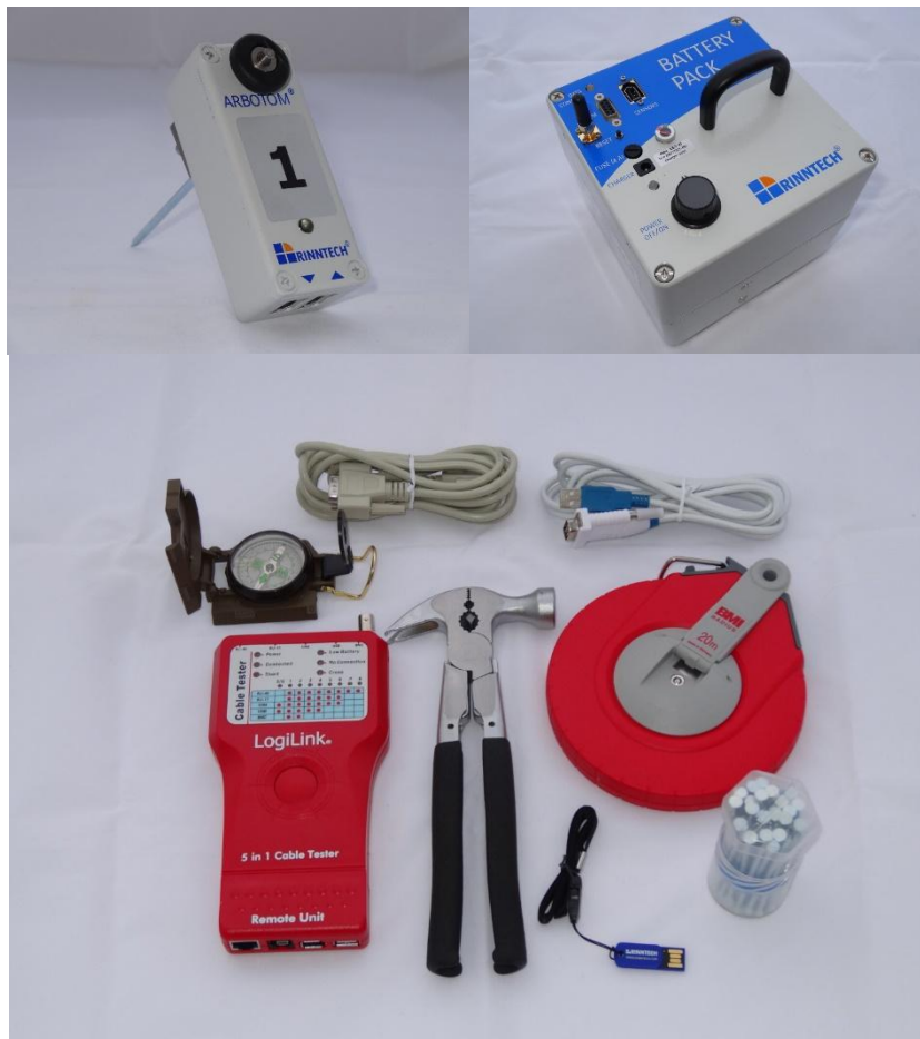
Slika 8. Prikaz dijelova zvučnog tomografa
