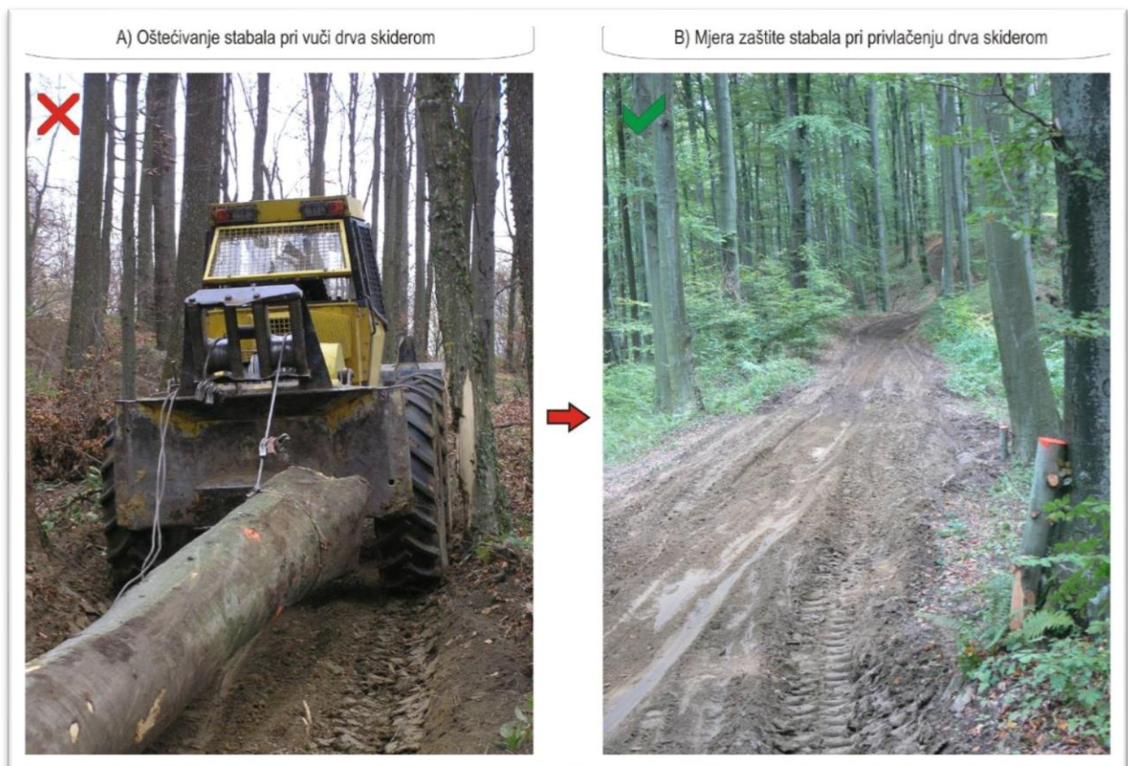
Slika 4. Oštećivanje i mjera zaštite dubućih stabala pri privlačenju drva skiderom
