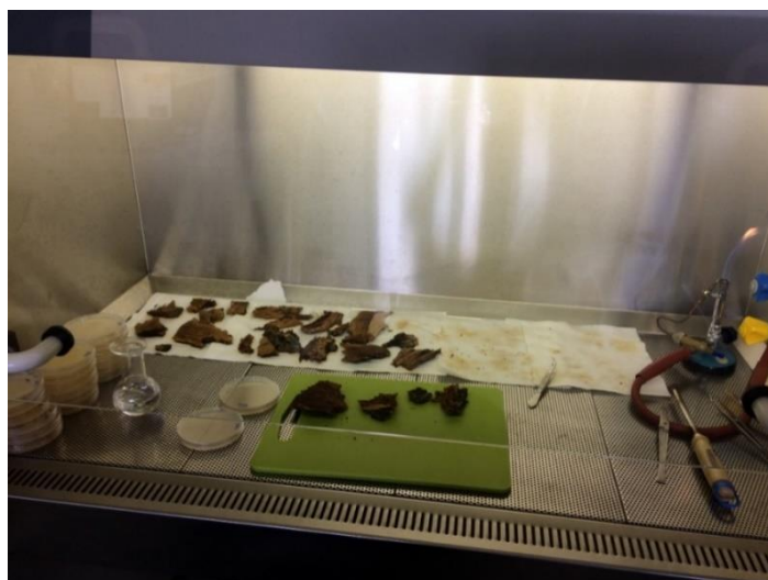
Slika 13. Prikaz laminarnog kabineta i potrebnog pribora za izolaciju gljiva i njima sličnih organizama iz biljnog tkiva
