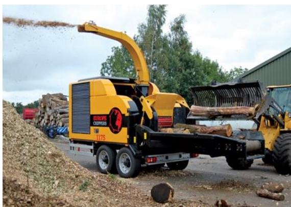
Slika 1. Iverač ugrađen na poluprikolicu
