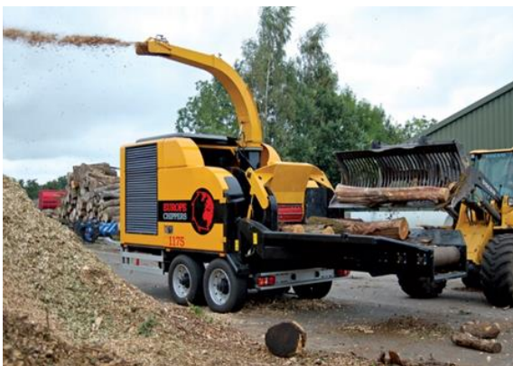
Slika 1. Iverač ugrađen na poluprikolicu
