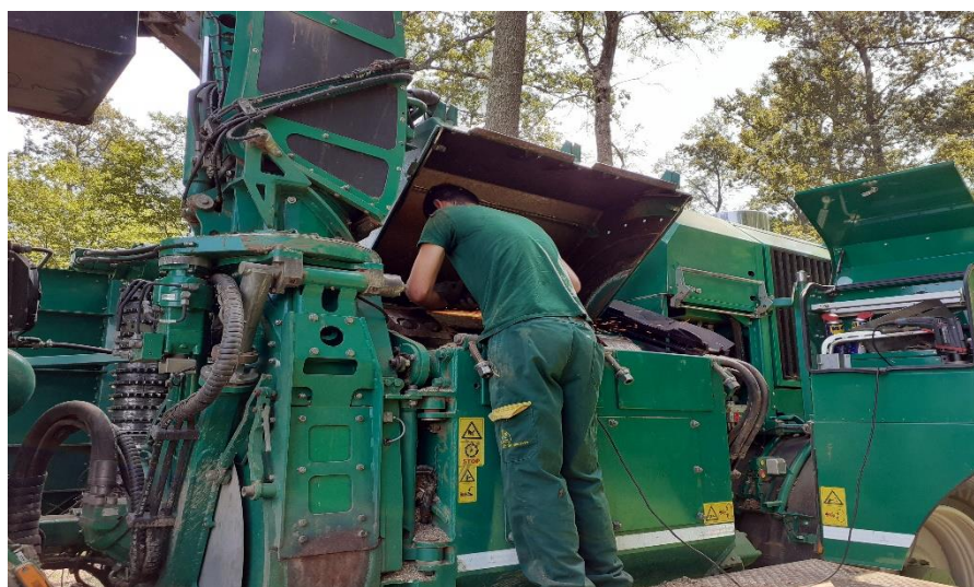
Slika 18. Oštrenje noževa na iveraču
