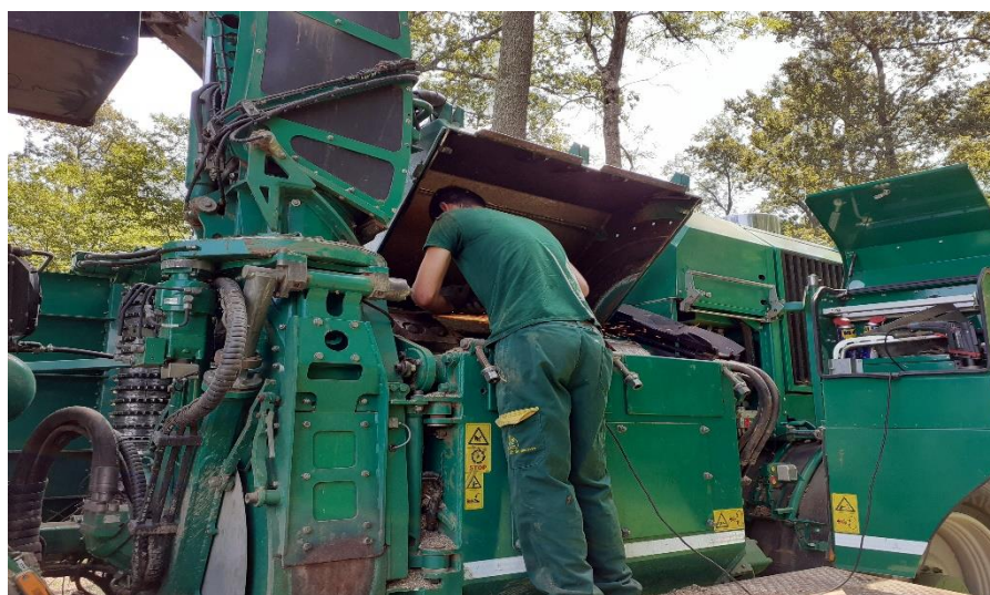
Slika 18. Oštrenje noževa na iveraču
