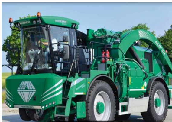
Slika 2. Samohodni iverač - Albach
