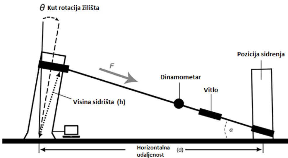
**Slika 11.** Shematski prikaz poteznog testa (Ghani, 2009)
