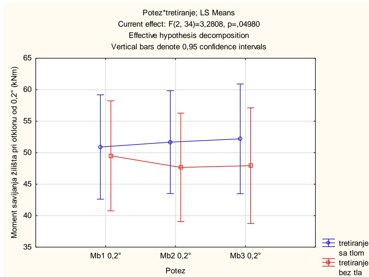
**Slika 15.** Moment savijanja žilišta pri otklonu od  $0,2^\circ$  prije i nakon uklanjanja tla
