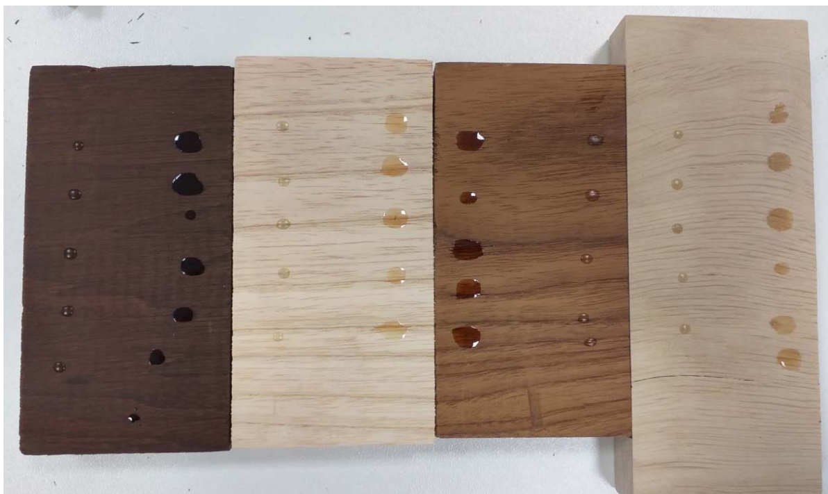
Slika 35. Izgled kapi premaza na uzorcima drva
