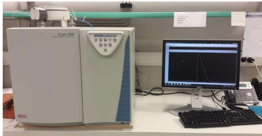
Slika 15. Određivanje udjela organskog ugljika i ukupnog dušika suhim spaljivanjem na NC analizatoru „NC Soil Flash 2000 elemental analyser“ (Thermo Fisher Scientific, Milan, Italy)
