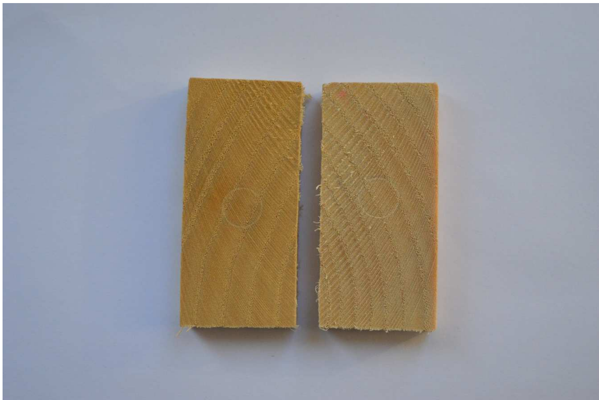
Slika 25. UV tretirani uzorak (lijevo) i UV netretirani uzorak (desno) nakon parenja.
