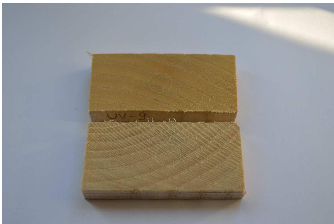
**Slika 26.** UV tretirani uzorak (gore) i UV netretirani uzorak (dolje) nakon parenja.
