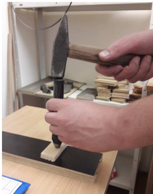
Slika 13. Označavanje uzorka probijačem.
