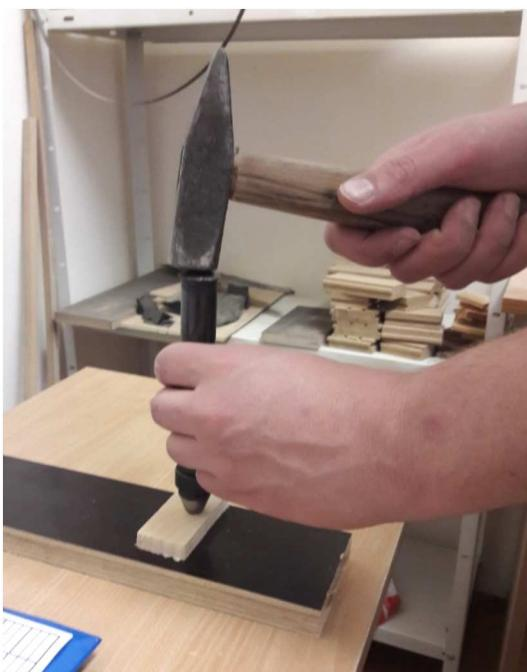
**Slika 13.** Označavanje uzorka probijačem.
