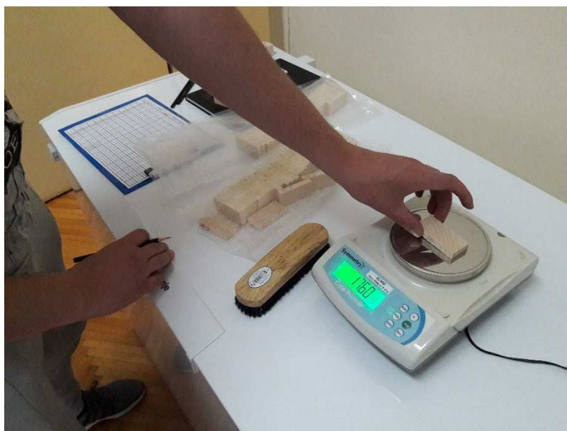
Slika 14. Četkanje i vaganje uzoraka.
