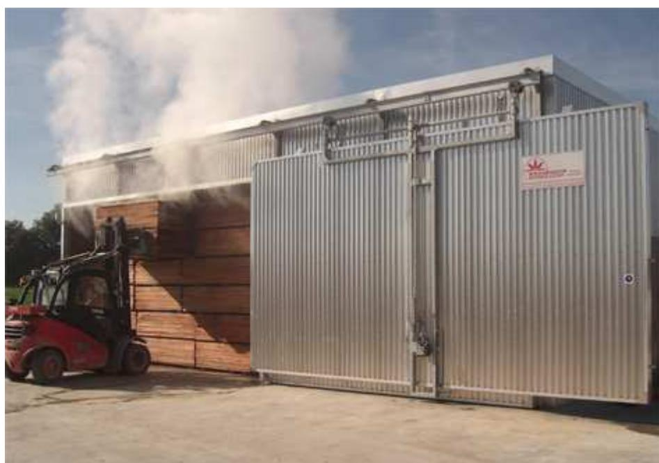
**Slika 1.** Parenje piljenica zasićenom vodenom parom (izvor: Termolegno, 2019)
