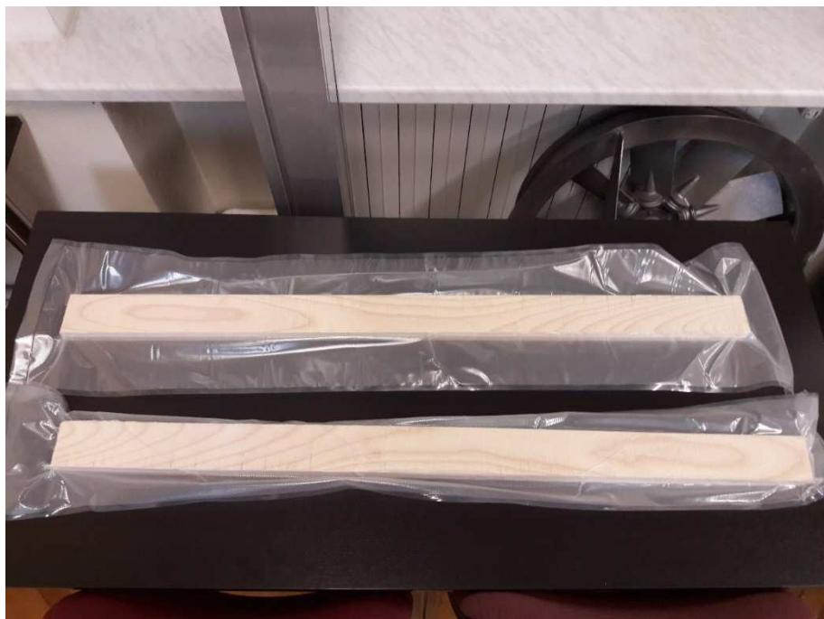
**Slika 12.** Ispiljeni i vakuumirani uzorci drva jasena.
