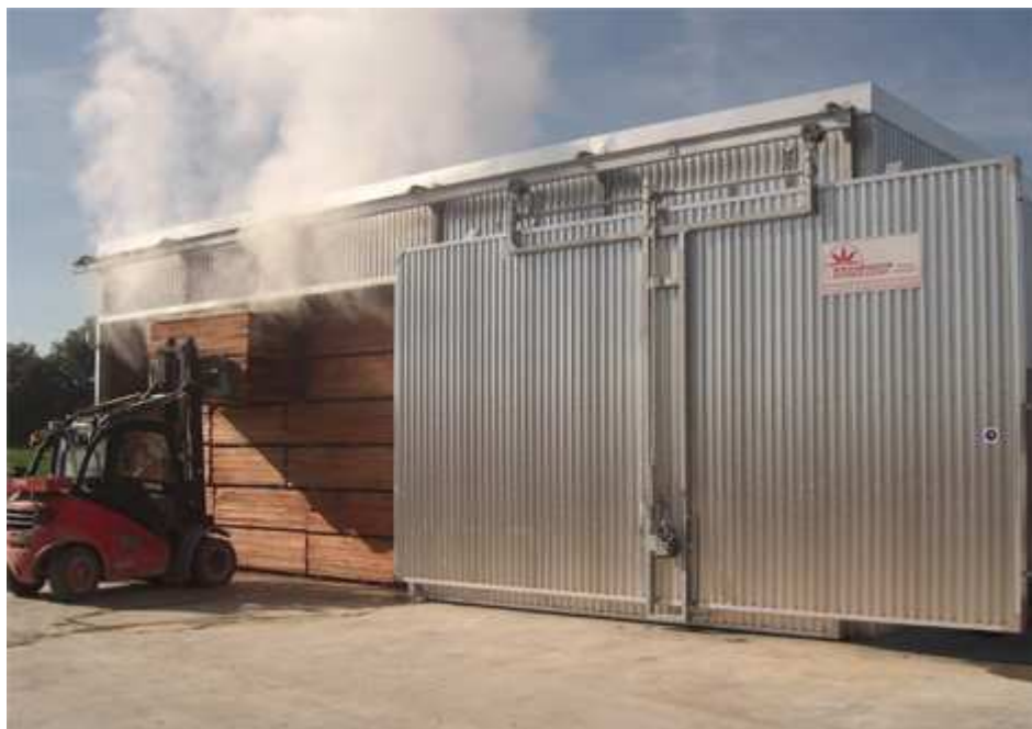
Slika 1. Parenje piljenica zasićenom vodenom parom (izvor: Termolegno, 2019)
