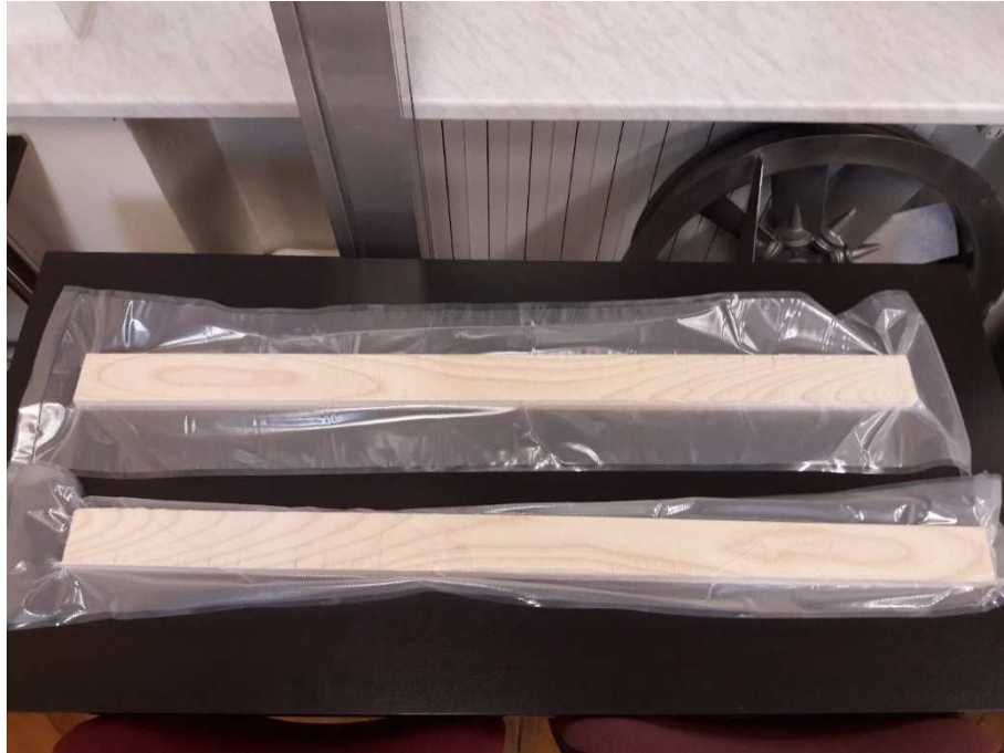
Slika 12. Ispiljeni i vakuumirani uzorci drva jasena.
