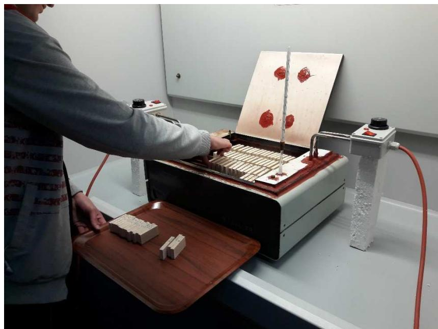
*Slika 19.* Priprema uzoraka za proces parenja vodenom parom.
