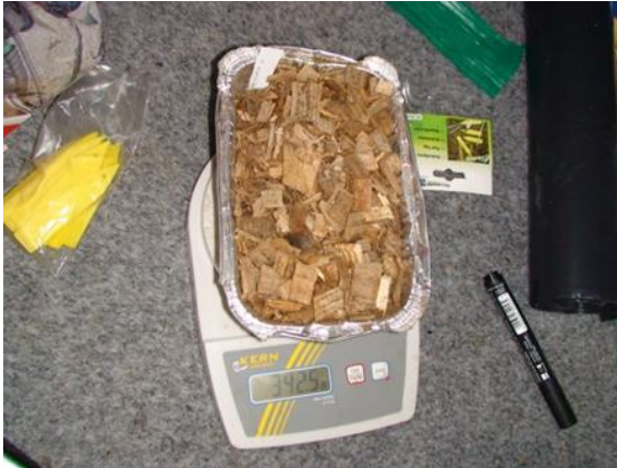
Slika 10. Određivanje početne mase uzoraka
