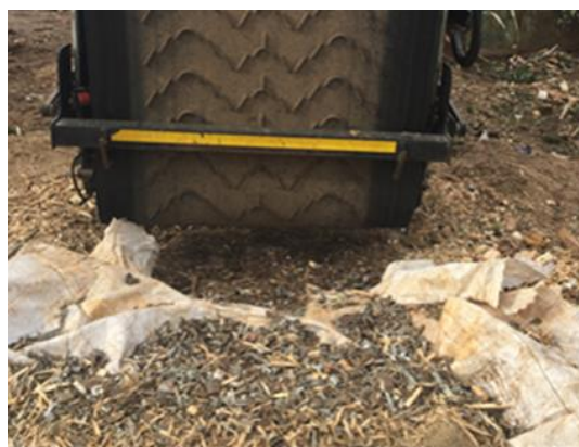
Slika 7. Odvajanje metalnih frakcija magnetom
