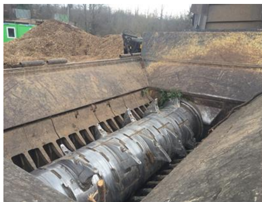
Slika 5. Rotor za usitnjavanje lomljenjem
