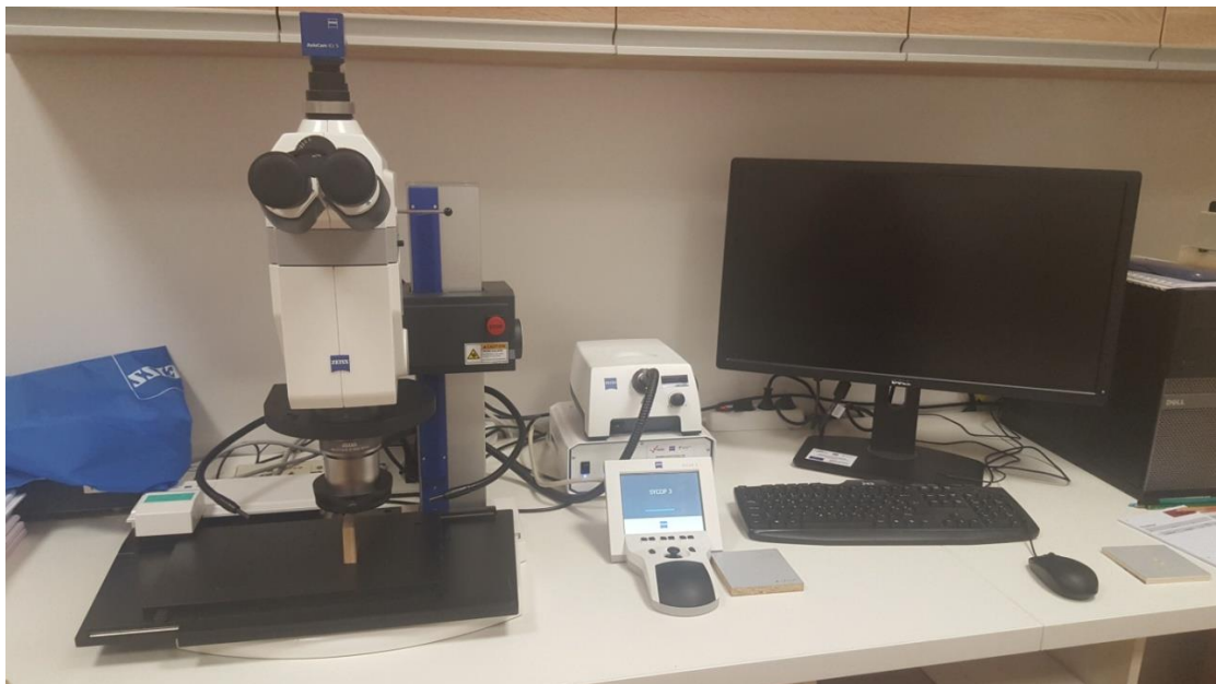
Slika 12. Mikroskop za mjerenje suhe debljine filma premaza
