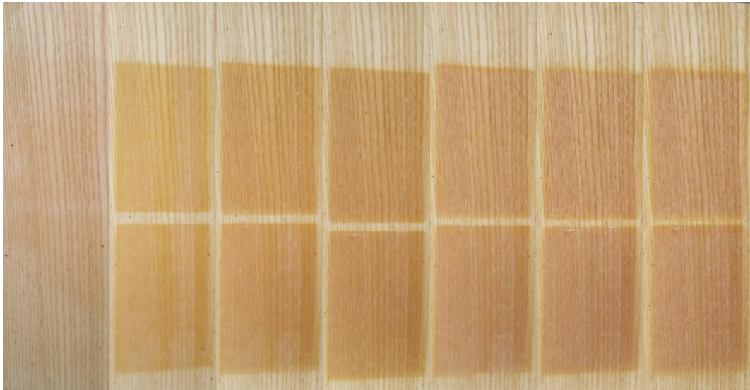
Slika 48. Uzorci N-F-1-2 (tijekom izlaganja 1h, 168h, 336h, 504h, 672h, 840h, 1008h)
