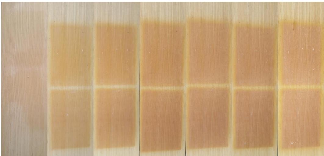
Slika 44. Uzorci N-B-1-2 (tijekom izlaganja 1h, 168h, 336h, 504h, 672h, 840h, 1008h)
