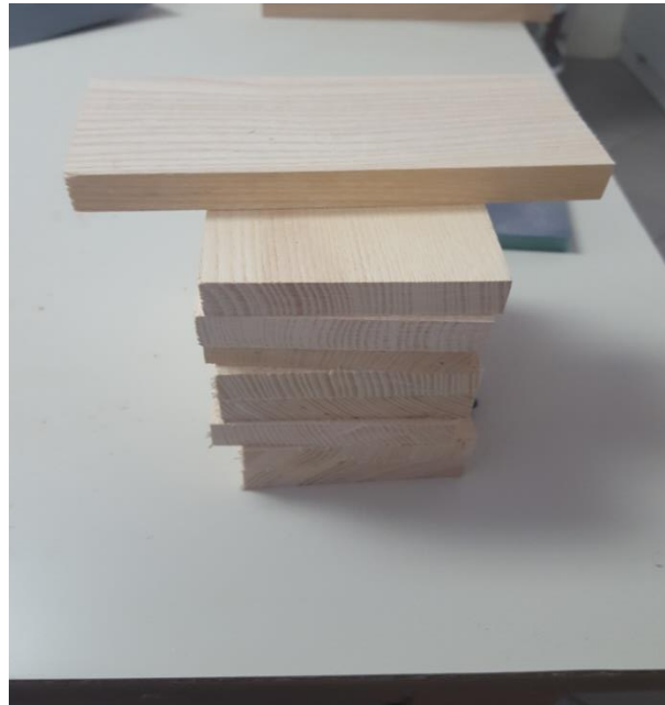
Slika 3. Nemodificirani uzorci drva jasena
