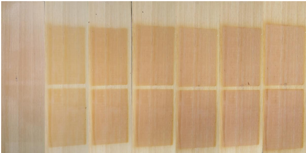
Slika 46. Uzorci N-D-1-2 (tijekom izlaganja 1h, 168h, 336h, 504h, 672h, 840h, 1008h)
