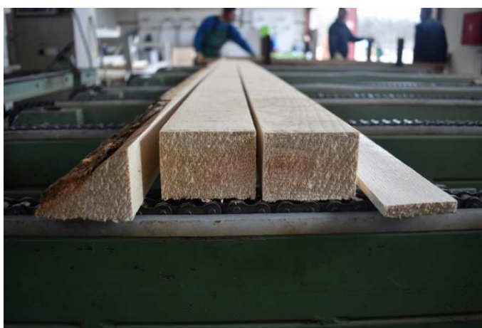
Slika 4. Jasenove gredice raspiljene na višelisnoj kružnoj pili.
