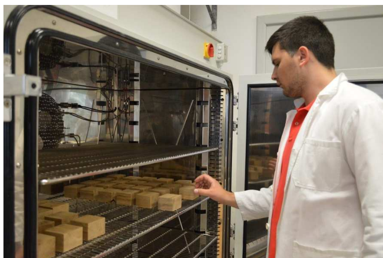
Slika 16. Slaganje uzoraka u klimatizacijsku komoru.
