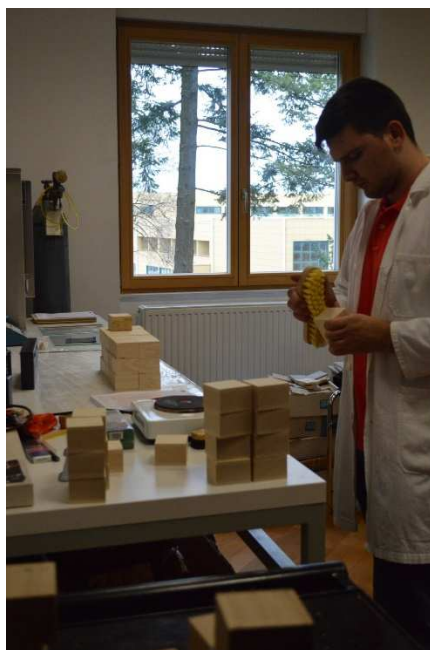
Slika 12. Čišćenje uzoraka od iverja.
