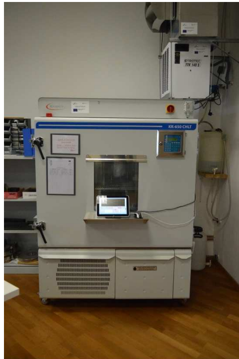
Slika 15. Klimatizacijska komora korištena u istraživanju.
