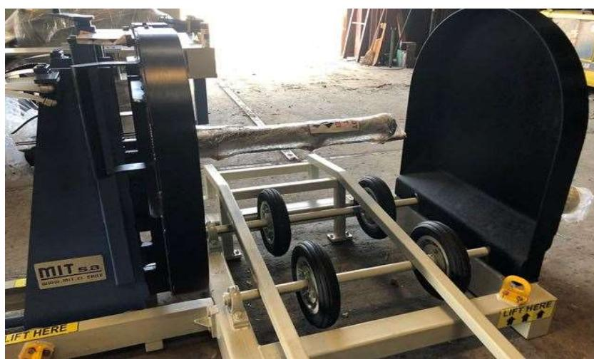
*Slika 18. Stroj za paljenje unutrašnjosti bačve*
