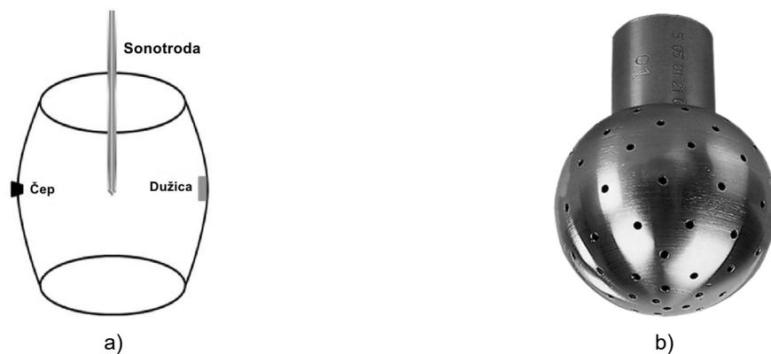
Slika 26. Princip čišćenja bačve ultrazvukom velike snage (HPU) (a), kuglica za prskanje (b)
