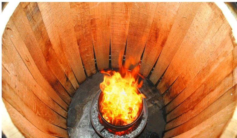
Slika 14. Unutrašnjost bačve i ložište prilikom oblikovanja plašta
