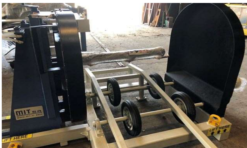
Slika 18. Stroj za paljenje unutrašnjosti bačve
