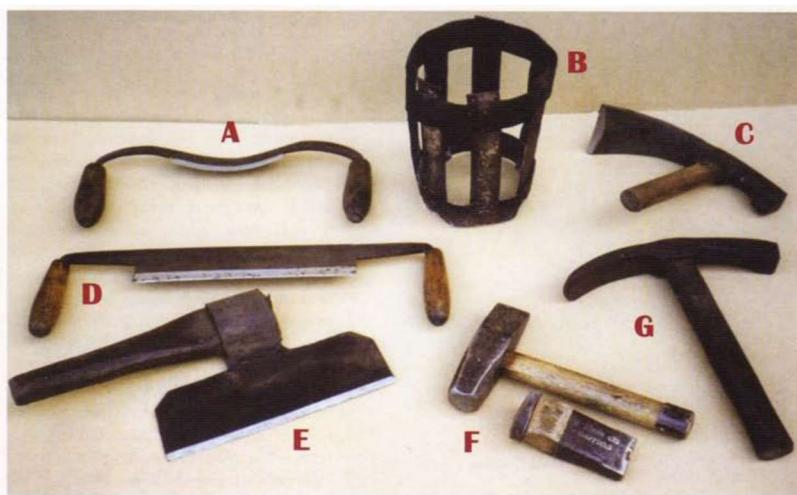
Slika 3. Osnovni ručni alat bačvara
