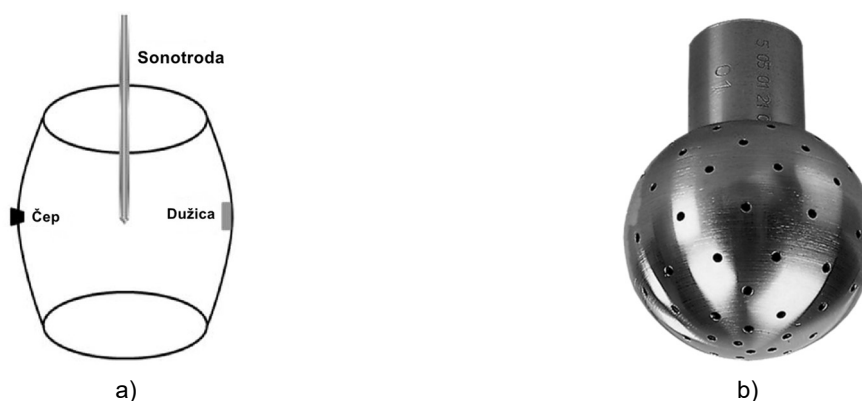
Slika 26. Princip čišćenja bačve ultrazvukom velike snage (HPU) (a), kuglica za prskanje (b)
