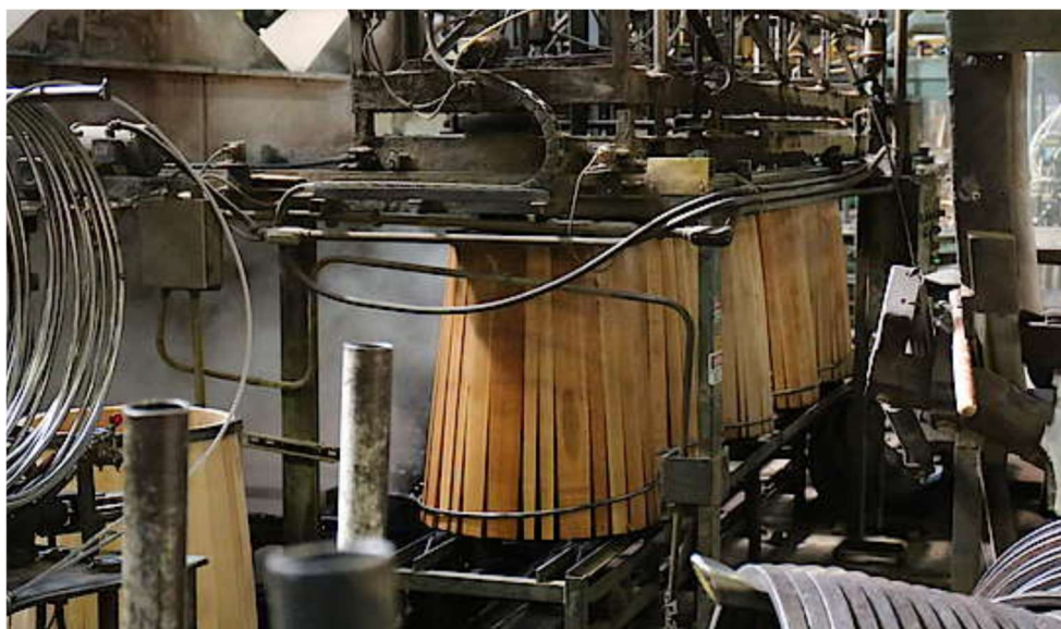
Slika 16. Parenje plašta bačve prije navlačenja drugog obruča
