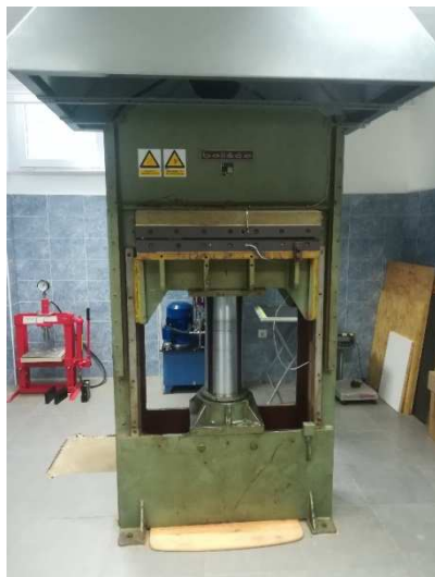
Slika 6. Postupak vrućeg prešanja
