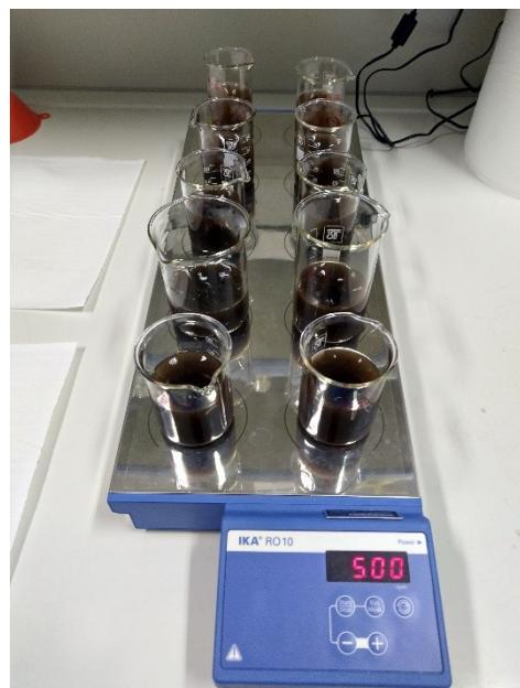
Slika 8. Priprema uzorka za određivanje topljivosti
