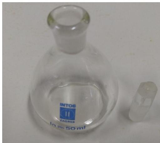
Slika 10. Piknometar zapremnine 50 ml.
