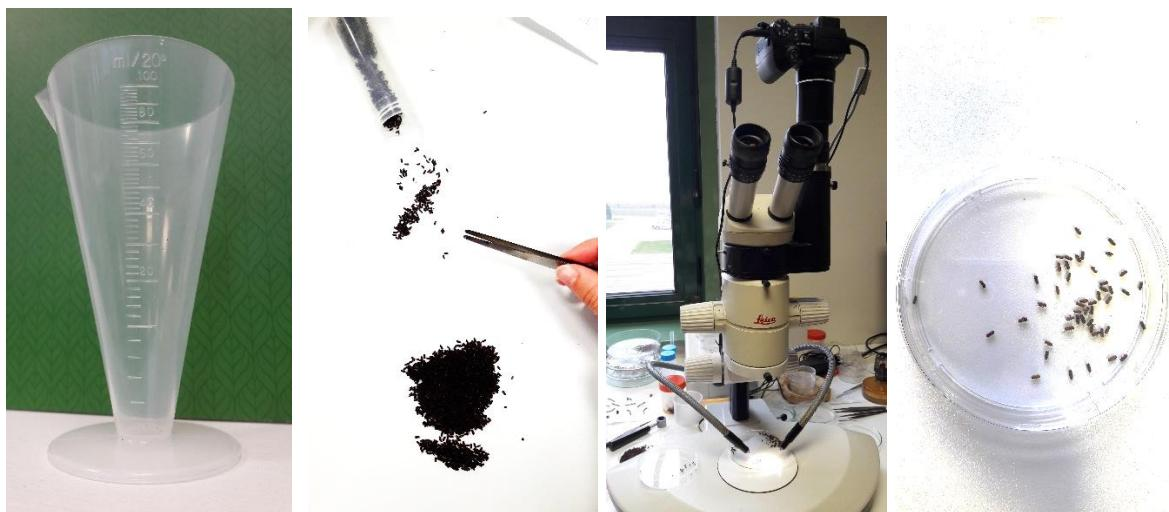
Slika 11. Pribor i materijal u laboratoriju (mjerni stalak, pinceta, binokularna lupa sa digitalnom kamerom i petrijeva zdjelica) (Izvor: original)
