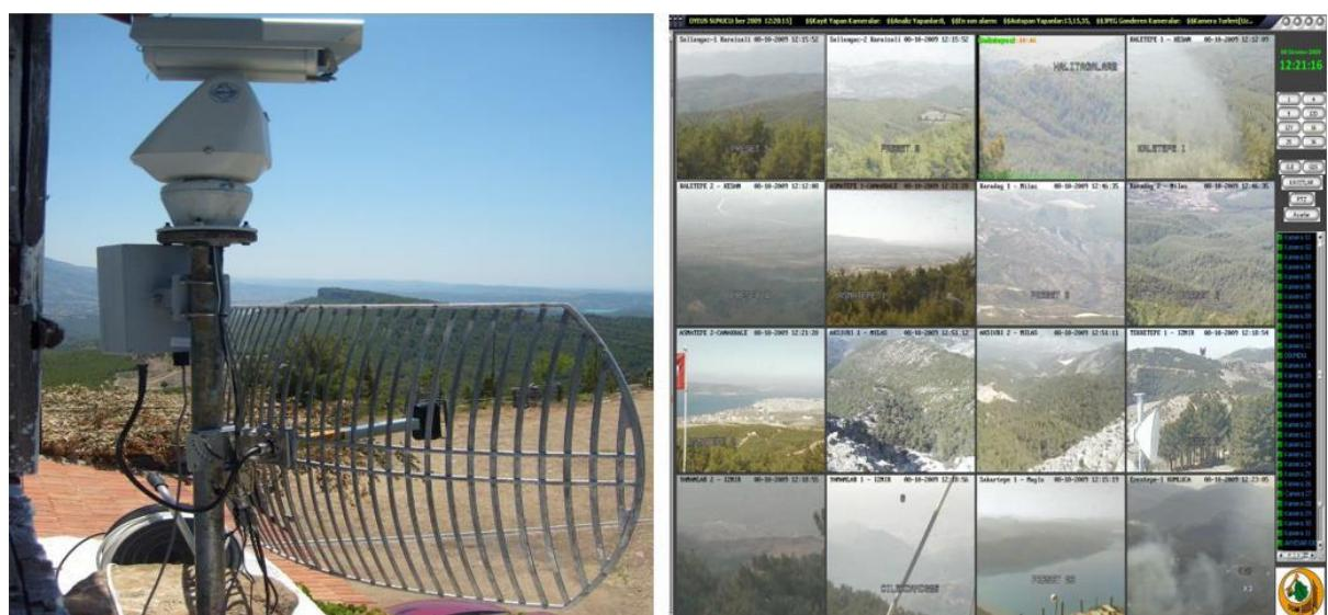
Slika 8. Sustav za detektiranje požara s kamerama i sustavom za slanje informacija centrali
