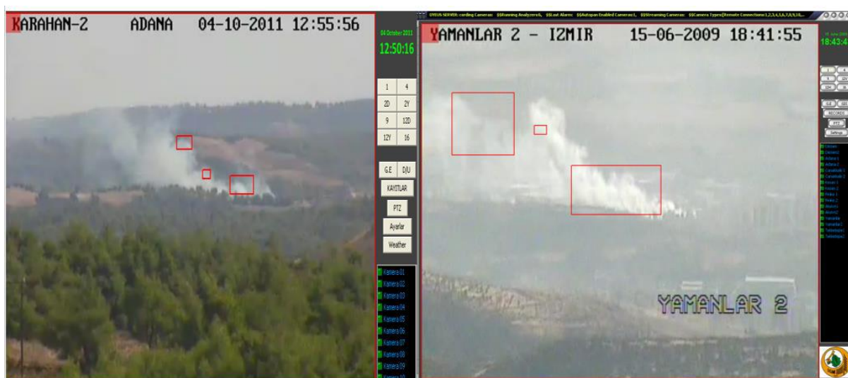
Slika 9. Prilikom detektiranja požara, sustav šalje informacije u 28 najbližih vatrogasnih centrala
