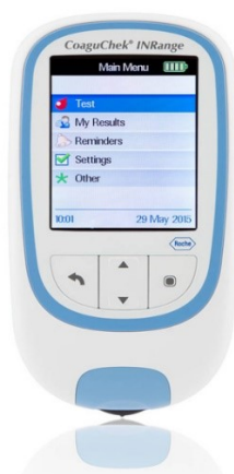
Slika 18 - Bluetooth uređaj za ispitivanje koagulacije krvi
