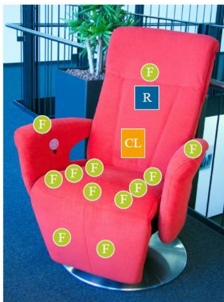
Slika 23. KogniChair stolica s integriranim senzorima F – senzor za očitavanje otpora sili; R – senzor za beskontaktno mjerenje rada srca i disanja; CL – kontrolna jedinica
