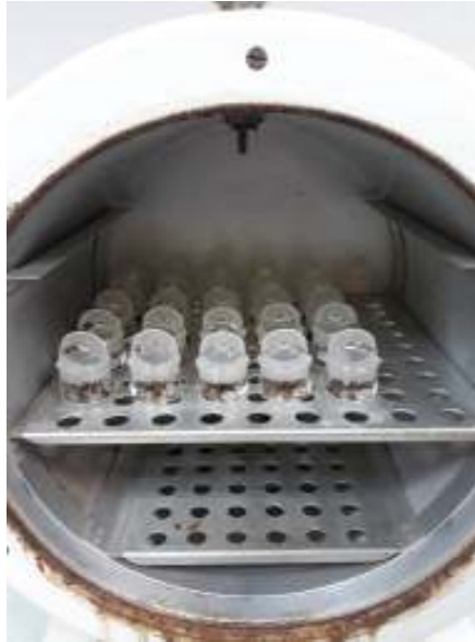
Slika 14: Uzorci u sušioniku
