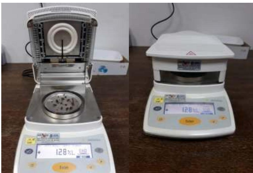
Slika 16: Određivanje sadržaja vode IC analizatorom Sartorius MA 150
