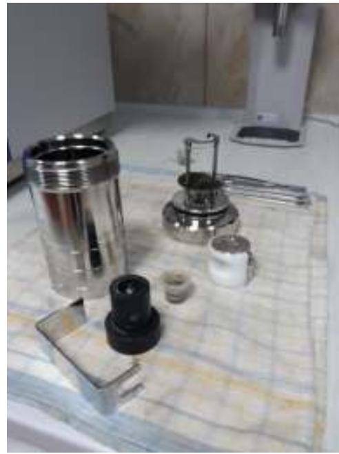
Slika 9: Dijelovi kalorimetarske bombe i oprema za rukovanje
