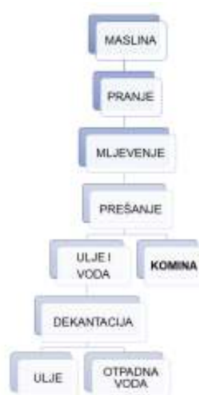
Slika 4: Shematski prikaz ekstrakcije maslinovog ulja tradicionalnim prešanjem
