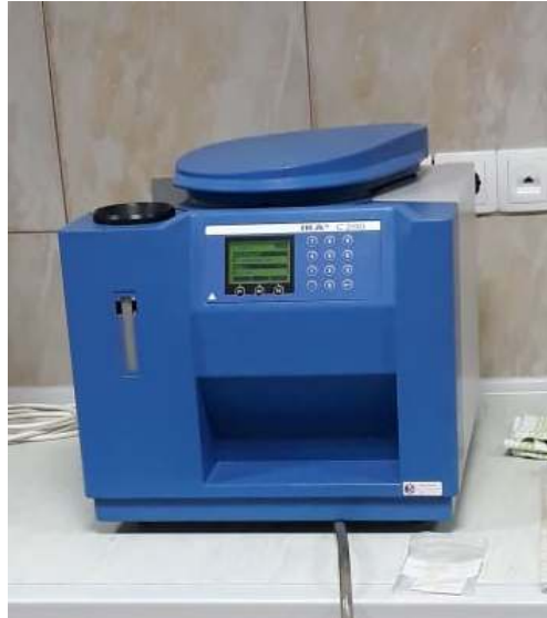
Slika 8: Kalorimetar IKA C200
