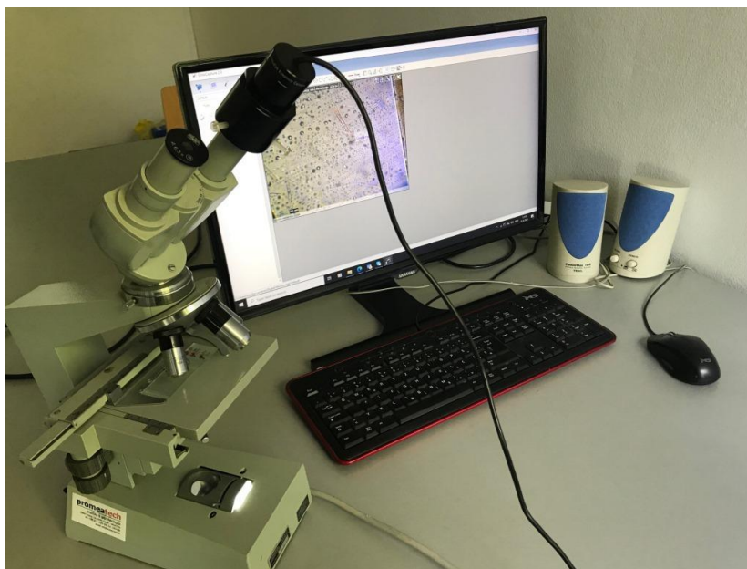
Slika 6. Radna stanica na kojoj je provedeno mjerenje duljine vlakana (Autor, 2020).
