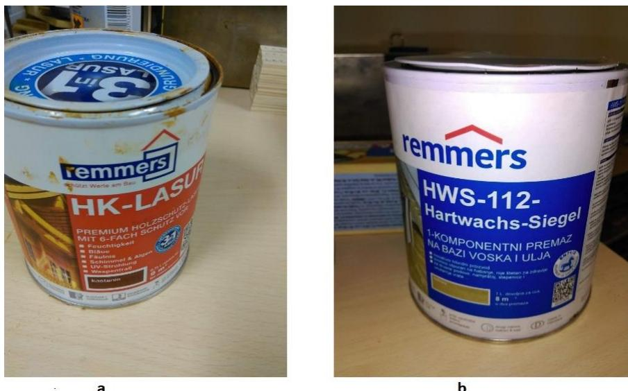
Slika 6 Korištene lazure za lazurni sustav zaštite: a) HK Lasur – kao temeljna kemijska zaštita, b) završni zaštitni sloj HWS-112 hibridnom lazurom
