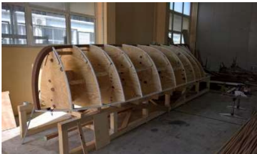
Slika 25. Kalup za izradu gajete
