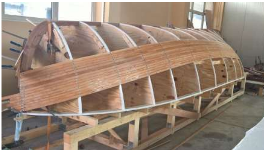
Slika 26. Izrada oplate gajete
