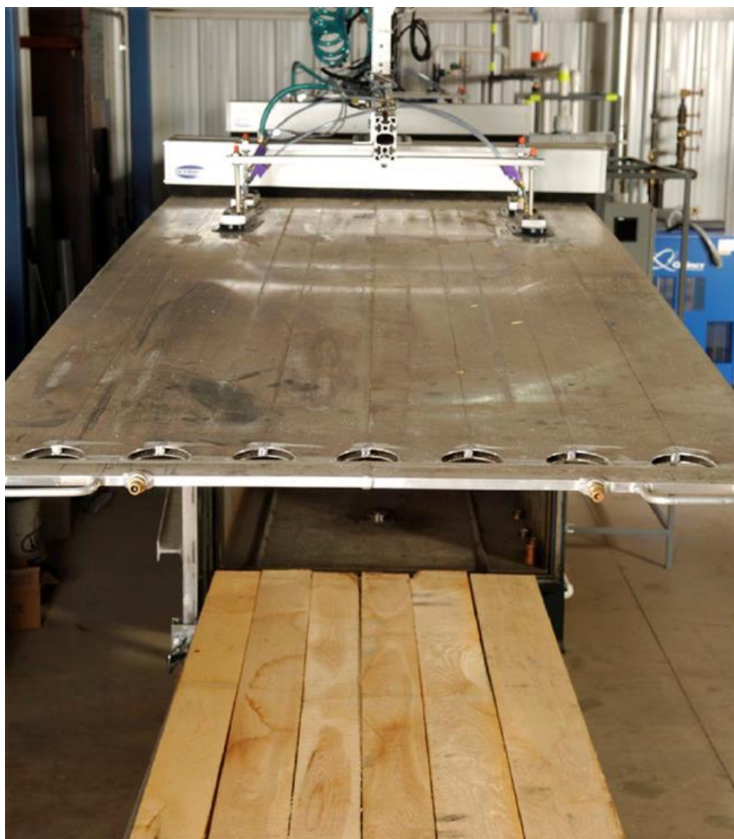
Slika 7. Manipulacija grijaćih ploča (izvor: https://idrywood.com/idry-standard , 15.8.2020.).
