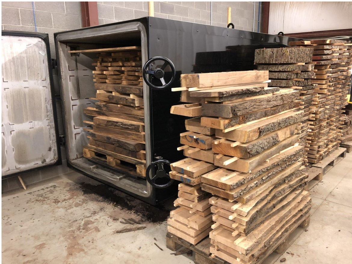
Slika 8. Sušenje cirkulacijom zagrijanog zraka (izvor: https://idrywood.com/idry-standard , 15.8.2020.)
