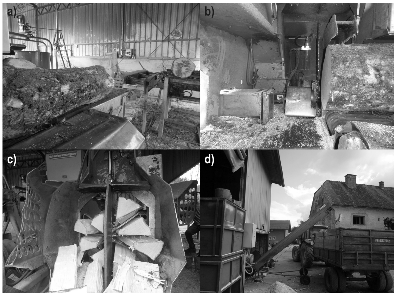
Slika 1. Radni zahvati pri izradi kratko rezanoga i cijepanoga ogrjevnoga drva: a) transport obloga energijskoga drva do mjesta prerezivanja; b) prerezivanje; c) cijepanje; d) transport kratko rezanoga i cijepanoga ogrjevnoga drva
