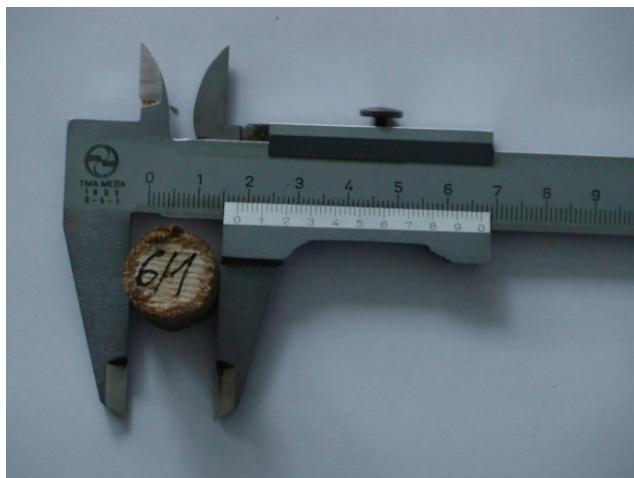
**Slika 10.** Stereometrijsko određivanje obujma uzorka
