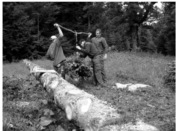
Slika 3. Utvrđivanje mase grana obične jele Fig. 3 Determining silver fir branch mass
