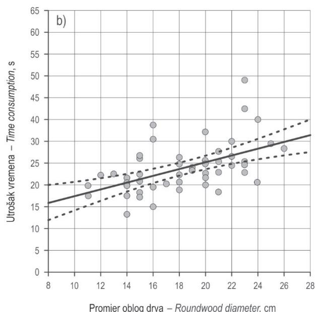
**Slika 4.** Odnos utroška vremena za prepiljivanje i promjera oblovine; a) obična bukva,**Fig. 4** Time consumption for cross-cutting vs. roundwood diameter; a) European beech; b) European hornbeam
