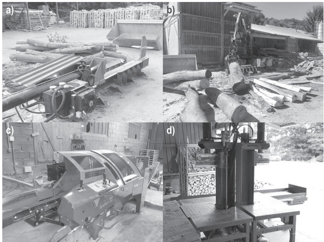
**Slika 1.** Strojevi u proizvodnom sustavu: a) horizontalni cjeptač, b) utovarni kran, c) procesor, d) vertikalni cjeptači
