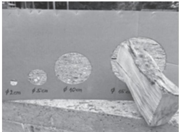
Slika 3. Pojednostavljena metoda mjerjenja promjera kratko rezanoga i cijepanoga drva
