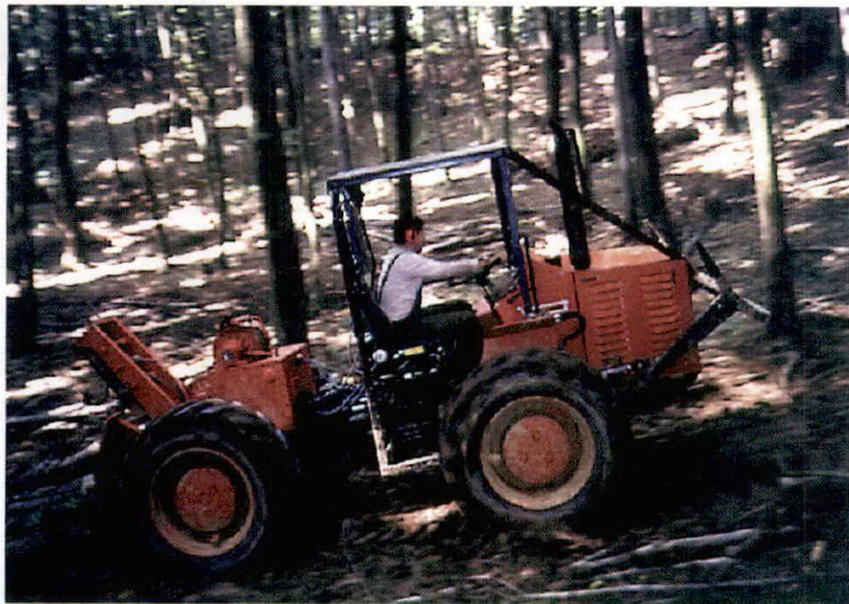
Figure 14. Driving a loaded Ecotrac V – 11 – 1033F at the felling site Slika 14. Vožnja opterećenog traktora Ecotrac V - 11 - 1033F po sječini
