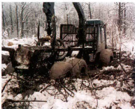
Figure 13. Limited soil strength Slika 13. Tlo ograničene nosivosti
