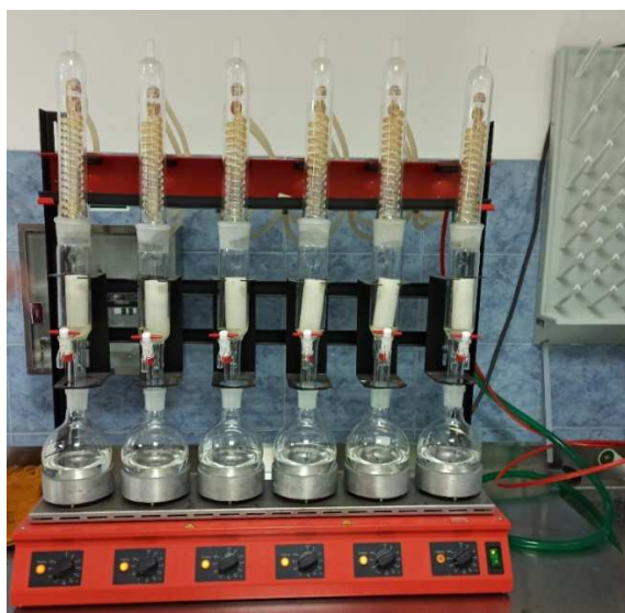
Slika 8. Proces ekstrakcije u Soxhletovom uređaju
