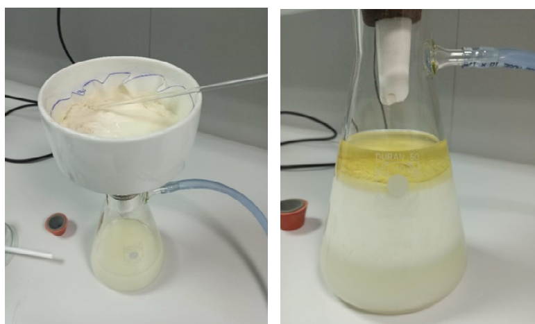
Slika 19. Filtracija i ispiranje produkata acetilacije
