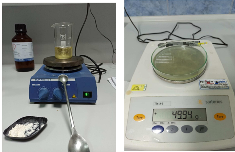
Slika 22. Priprema i izlivanje matrice (biokompozita)
