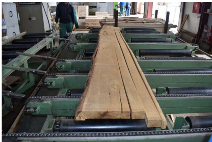
Slika 5. Hrastove gredice raspiljene na višelisnoj kružnoj pili (Izvor: Crnojević, 2019)
