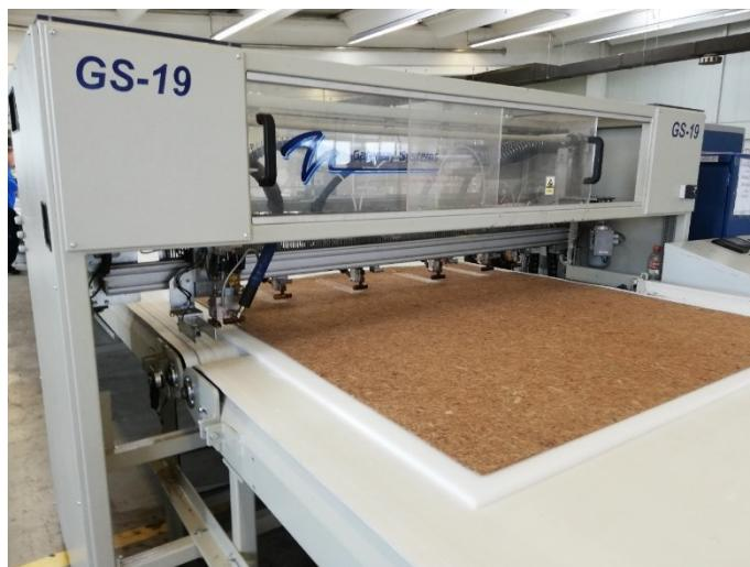
*Slika 15. Lijepljene obloga na tračnom transporteru*
