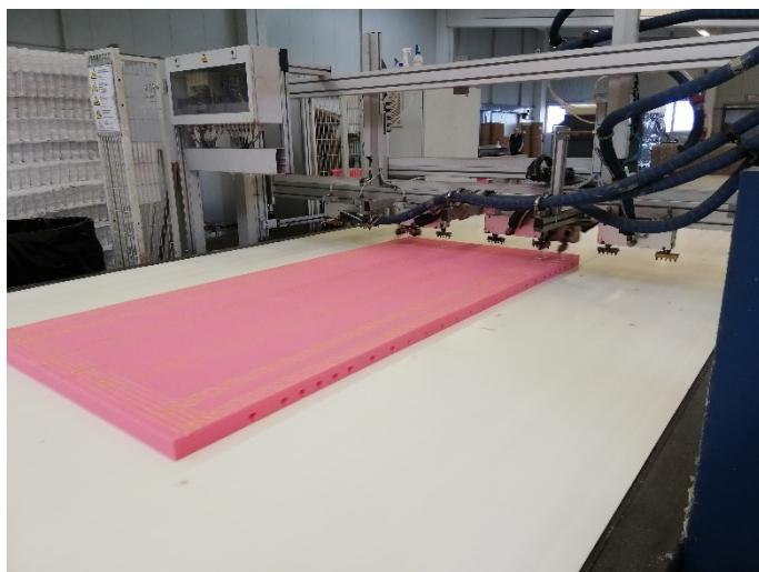
Slika 32. Nanošenje ljepila na oblogu od spužve
