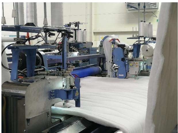
Slika 9. Set paralelnih strojeva za obradu ruba
