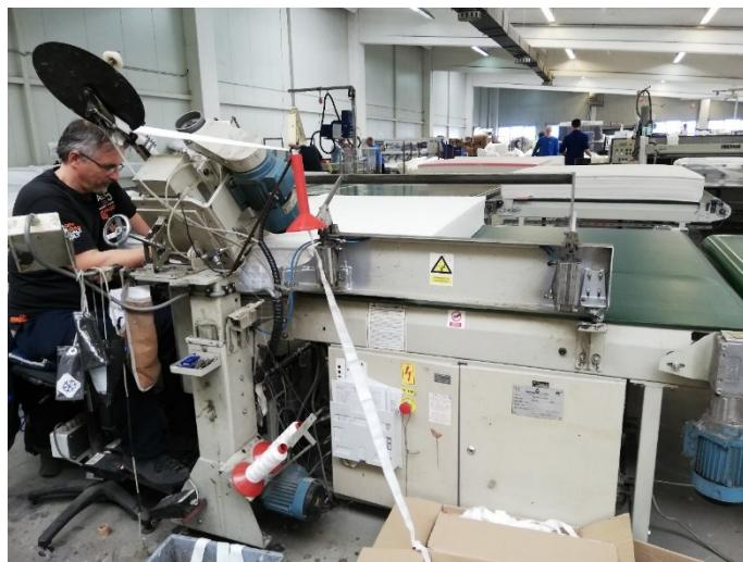
Slika 19. Šivanje rubova navlake pomoću tape- edge šivaćeg stroja
