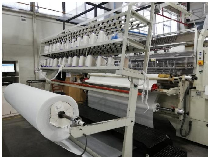
Slika 4. Ulazak repro materijala u višeigleni švaći stroj
