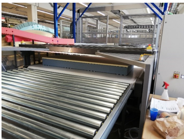
Slika 48. Ulazak jezgre u prešu
