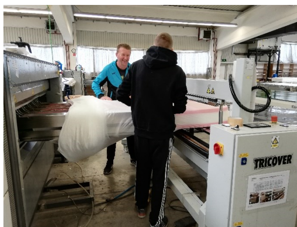
b) navlačenje triko navlake
