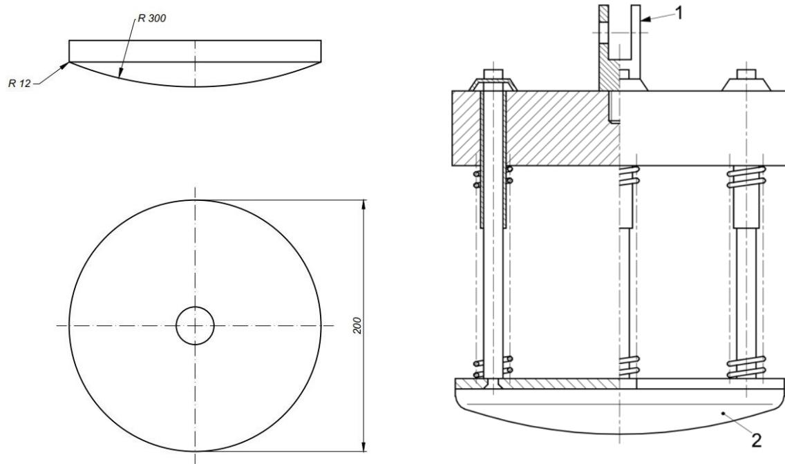
*Slika 52. Pritisno tijelo za ispitivanje izdržljivosti madraca*
