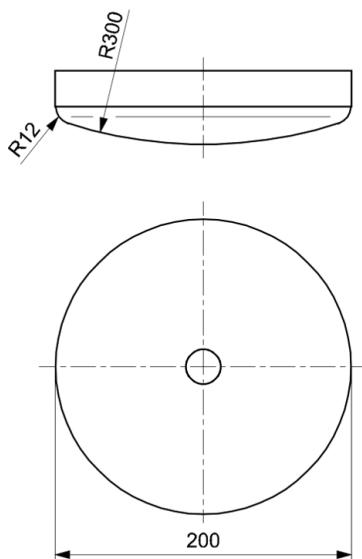
*Slika 61. Pritisno tijelo za ispitivanje tvrdoće i izdržljivosti*
