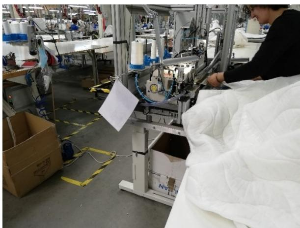
Slika 44. Stroj za izradu uglova
