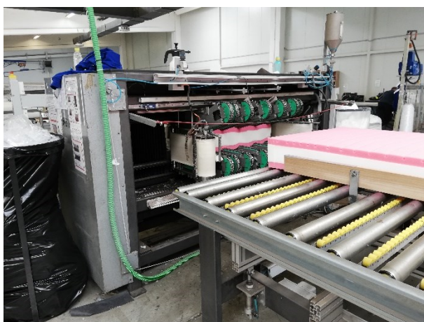
a) uvlačenje rohlinga u stroj
