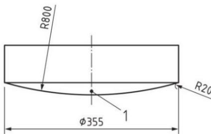
*Slika 58. Pritisno tijelo za ispitivanje elastičnosti*
