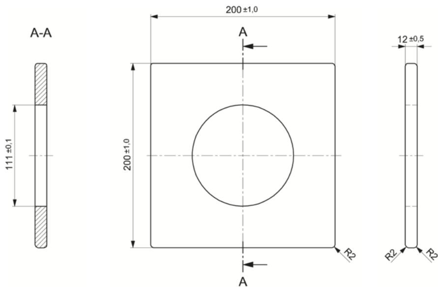
*Slika 62. Kruti podložak za ispitivanje čvrstoće*
