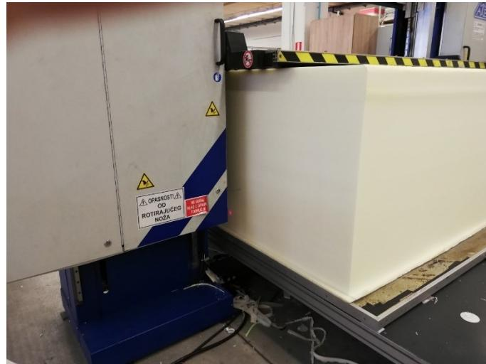
Slika 12. Rezanje sružne spužve
