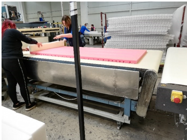
Slika 33. Lijepljenje okomica na oblogu
