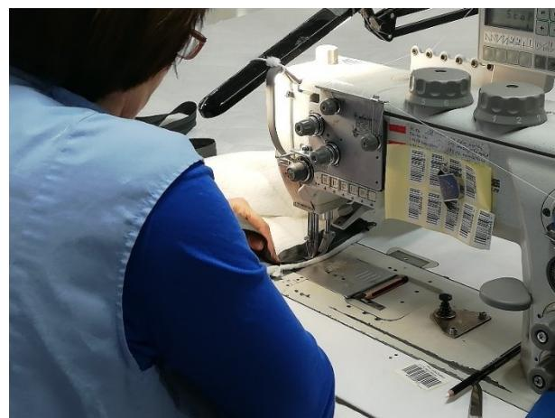
Slika 45. Šivanje patentnog zatvarača na plohu
