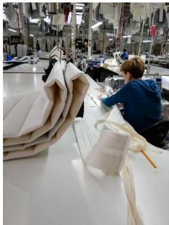
Slika 27. Šivanje patentnog zatvarača na border
