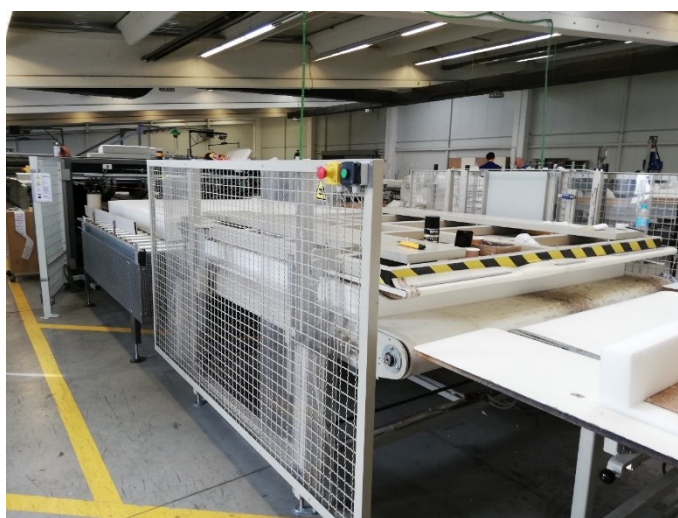
Slika 17. Prešanje nosivog sloja madraca
