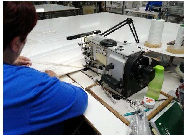
Slika 28. Šivanje patentnog zatvarača na donju plohu navlake
