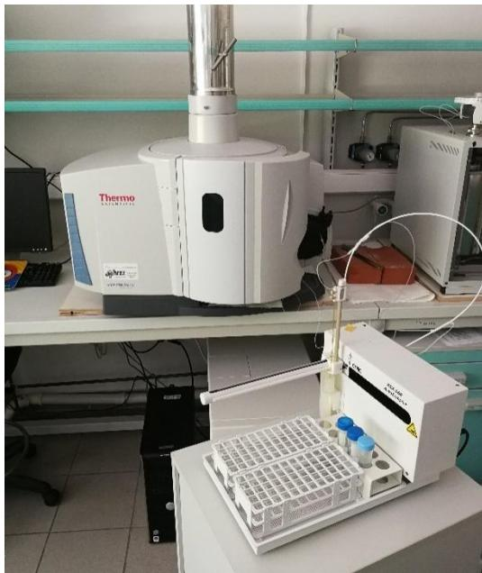
**Slika 6.** Emisijski spektrometar ICP-OES
